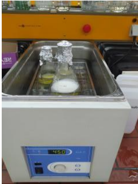
Εικόνα 4.5. Διάταξη αντίδρασης όξινου ορού γιαουρτιού με την χρήση β-γαλακτοζιδάσης από A.oryzae
