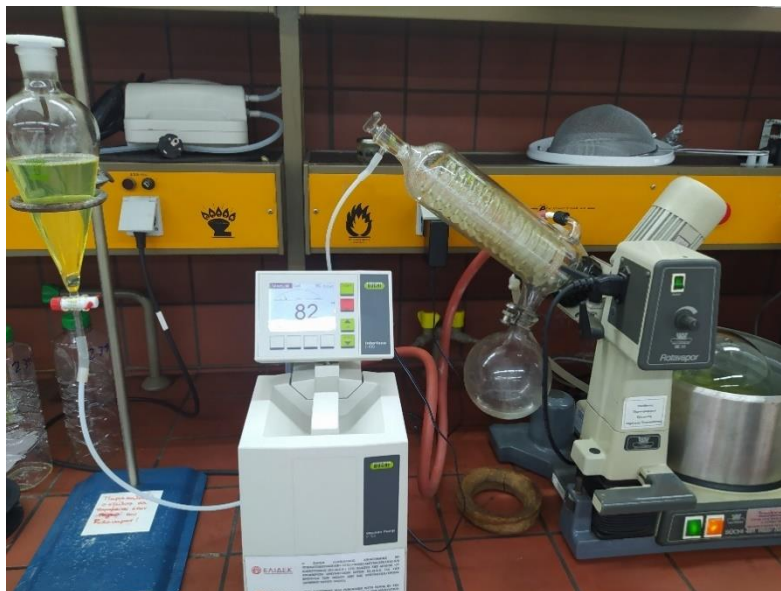
Εικόνα 4.2. Εργαστηριακή διάταξη συμπύκνωσης υπό κενό
