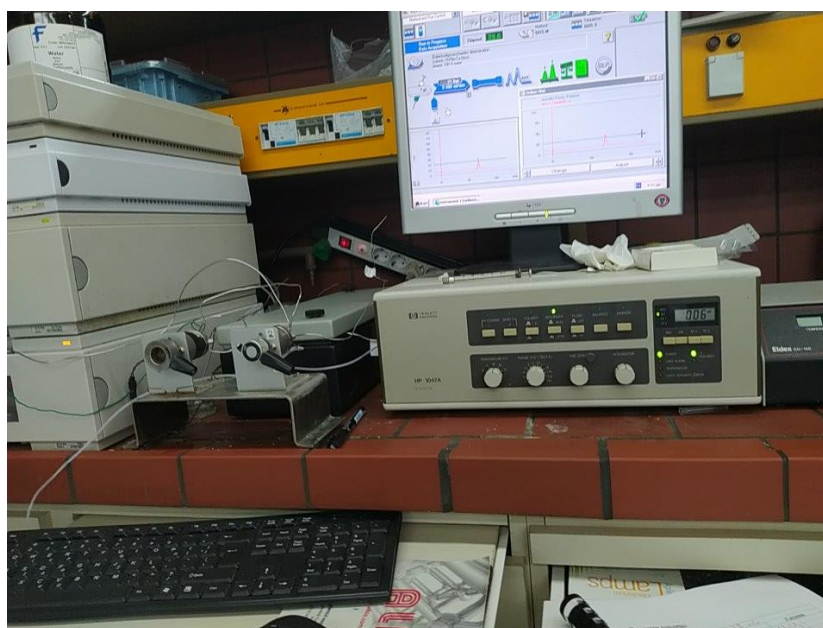
Εικόνα 4.4. Διάταξη υγρής χρωματογραφίας υψηλής απόδοσης με ανιχνευτή δείκτη διάθλασης
