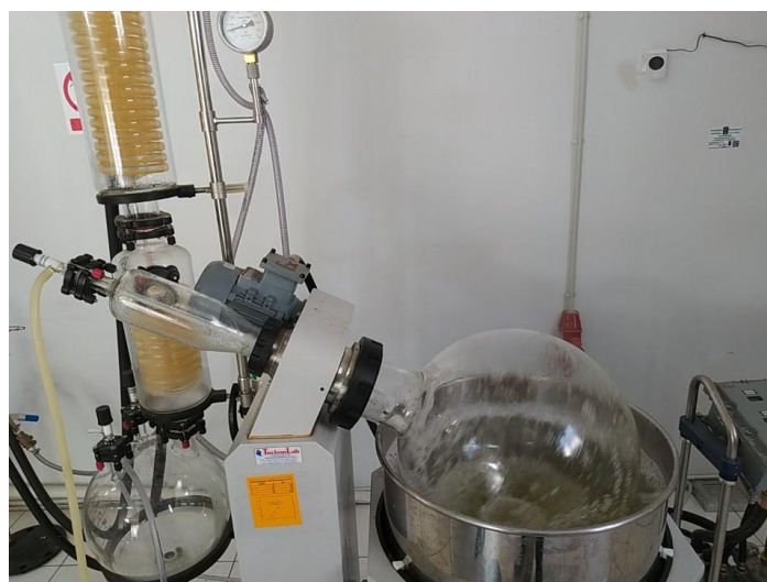
Εικόνα 4.3. Διάταξη πιλοτικής κλίμακας για την συμπύκνωση υπό κενό
