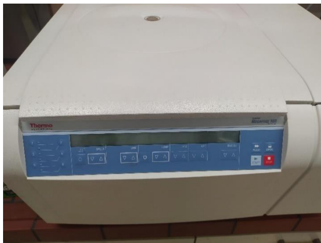
Εικόνα 4.11. Φυγοκεντρικό σύστημα Thermo SCIENTIFIC MEGAFUGE 16R
