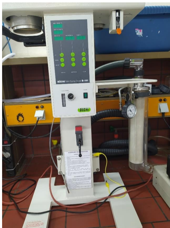
Εικόνα 4.7. Συσκευή ξήρανσης με ψεκασμό Büchi Mini Spray Dryer B-191
