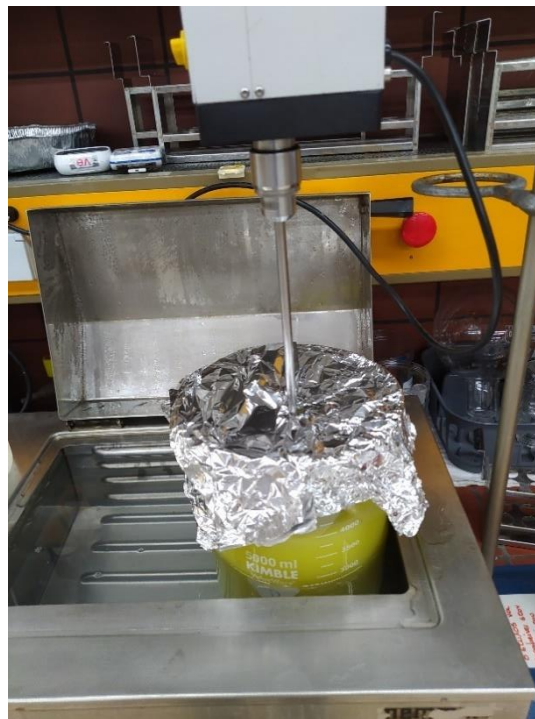
Εικόνα 4.6.. Διάταξη αντίδρασης όξινου ορού γιαουρτιού με την χρήση β-γαλακτοζιδάσης από A.oryzae σε αρχικό όγκο διαλύματος 3L.
