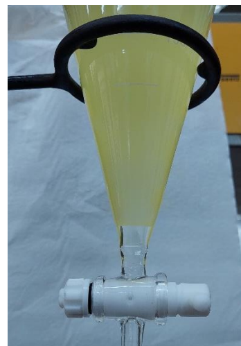
Εικόνα 36: Διάφανες στρώμα από τον καθαρισμό βιοντήζελ από κραμβέλαιο με κιτρικό οξύ.
