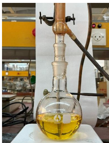
Εικόνα 30: Πειραματική διάταξη μετεστεροποίησης.
