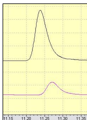
Γράφημα 27: Σύγκριση του χρωματογραφήματος του δείγματος ελαίου καρύδας (ροζ) με το πρότυπο 1-mono-C14:0 (μαύρο).
