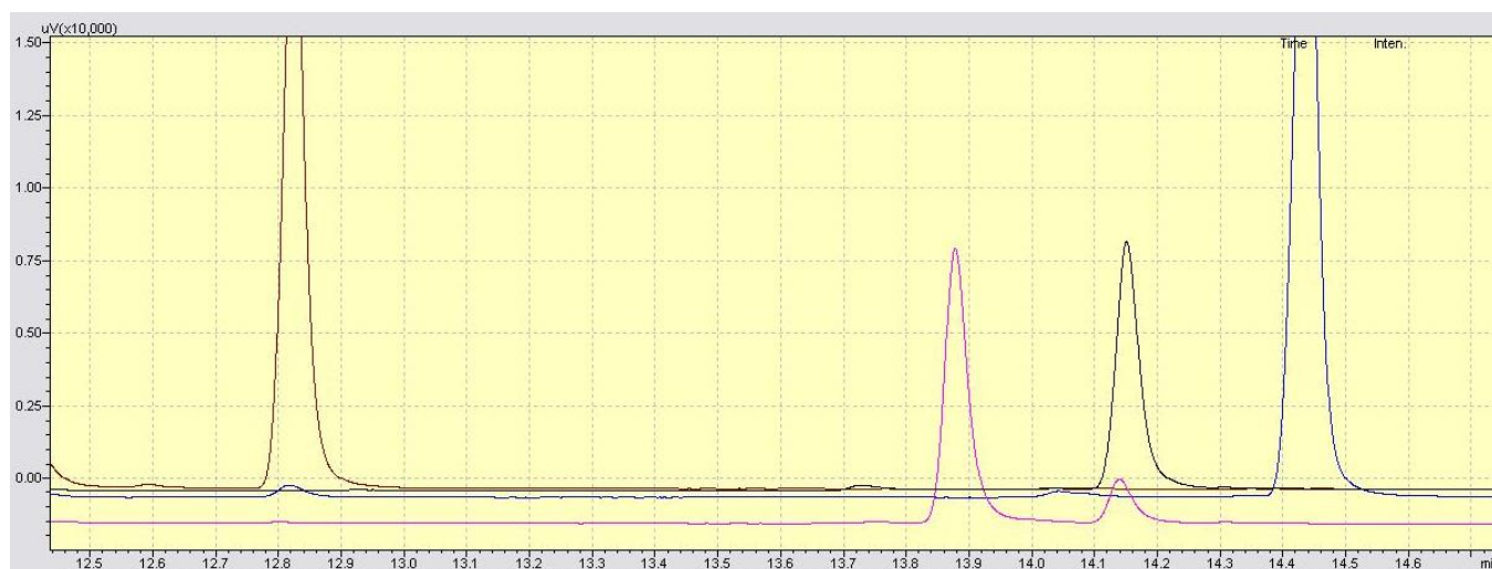
Γράφημα 17: Σύγκριση χρωματογραφημάτων των 1-mono-C16:0 (μπορντό), 2-mono-C18:1 (ροζ), 1-mono-C18:1 (μαύρο) και 1-mono-C18:0 (μπλε).
