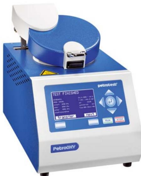
Εικόνα 69: Συσκευή PetroOXY της Petrotest. [151]
