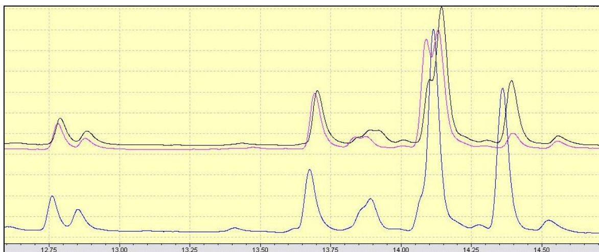
Γράφημα 36: Χρωματογράφημα του M7 (μαύρο), σε σύγκριση με το σησαμέλαιο (ροζ) και το πυρηνέλαιο (μπλε).
