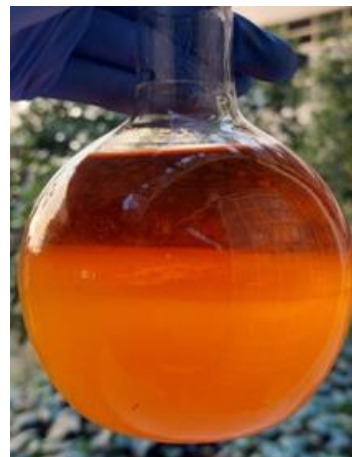
Εικόνα 33: Αποτέλεσμα όξινης εστεροποίησης ελαίου jatropha
