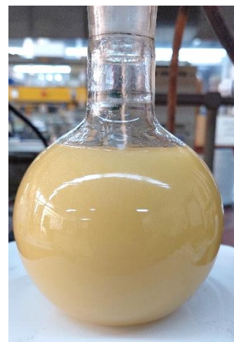
Εικόνα 40: Μορφή αντιδρώντος μίγματος κατά την έναρξη της μετεστεροποίησης.
