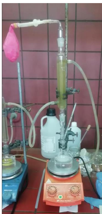
Εικόνα 39 : Πειραματική διάταξη για την αποδέσμευση αιθερίου ελαίου από το σύστημα εγκλεισμού
