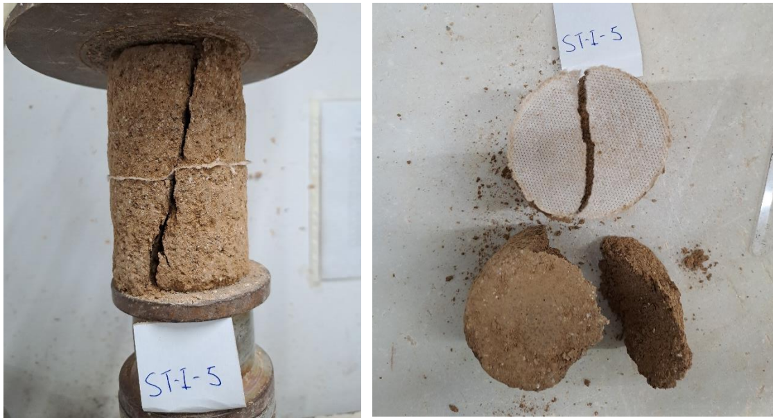
Σχήμα 5.5: Ψαθυρή αστοχία δοκιμίου (αριστερά) με παράλληλη αστοχία (σχίσσιμο) γεωυφάσματος (δεξιά)
