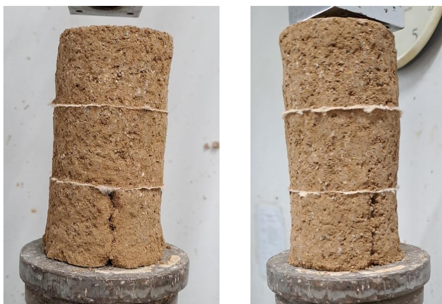
Σχήμα 5.3: Δοκίμια με επιφάνειες αστοχίας (πριν την θραύση) η οποίες δημιουργήθηκαν κατά την διαδικασία της διαμόρφωσης
