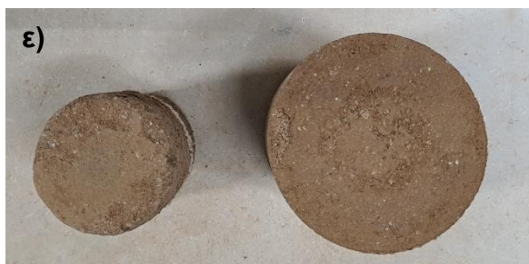
Σχήμα 4.16: α) Δοκίμιο πριν την μόρφωση και εργαλεία μόρφωσης β,γ και δ) Πλάγια όψη δοκιμίων μη οπλισμένων, οπλισμένων με μια και με δυο στρώσεις γεωφάσματος, αντίστοιχα, πριν και μετά την μόρφωση ε) Κάτοψη διαμορφωμένου και μη δοκιμίου στ) Επίπεδη άνω βάση δοκιμίου
