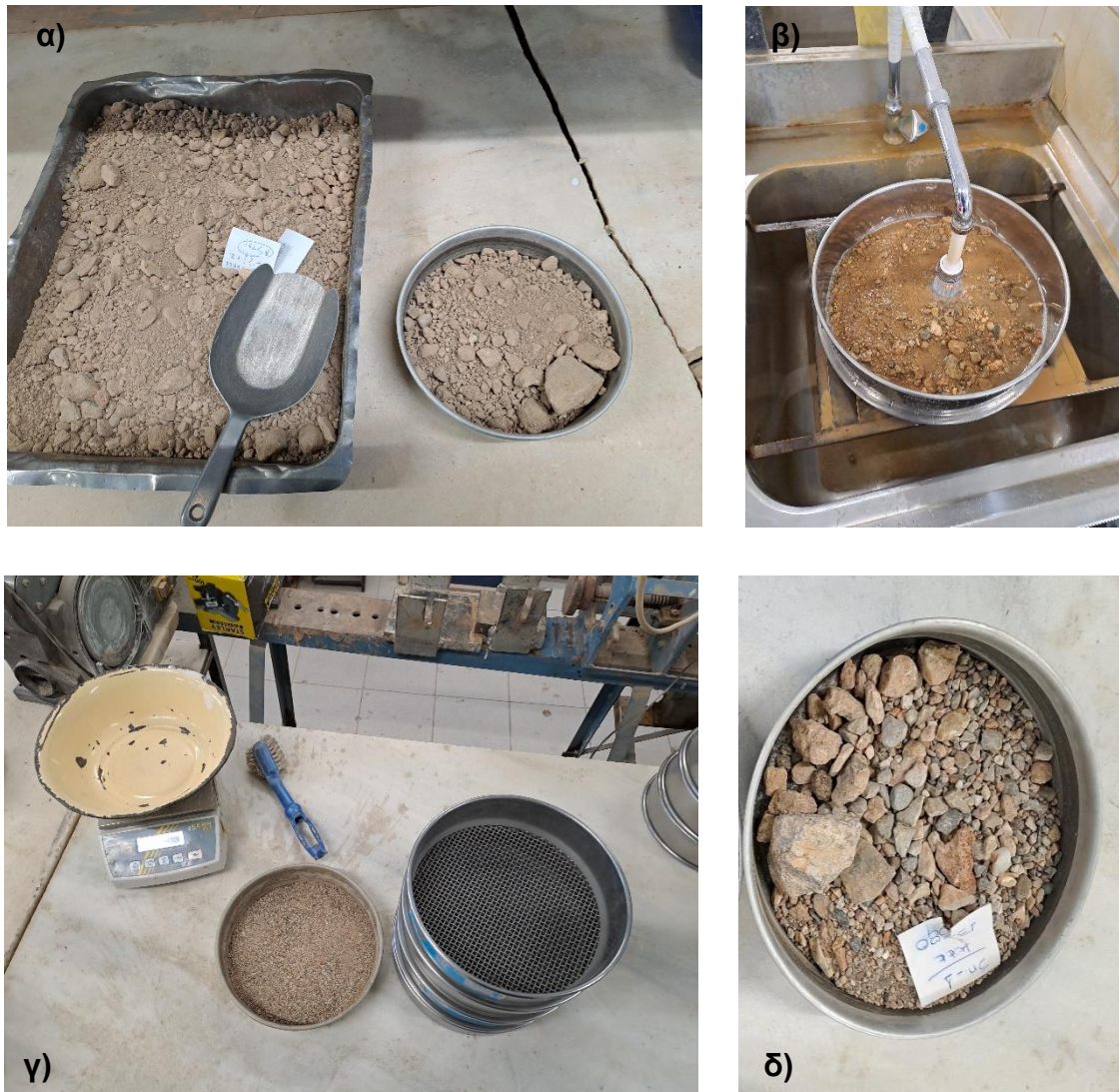
Σχήμα 4.6: α) Ξηρό υλικό μετά από τετραμερισμό β) Πλύσιμο υλικού γ) Διάταξη κοκκομέτρησης δ) Πλυμένο και ξηρό υλικό έτοιμο για κοκκομέτρηση.
