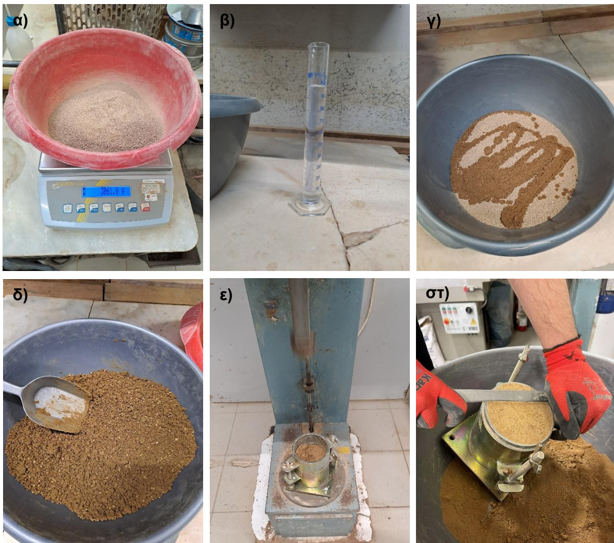
Σχήμα 4.11: Διαδικασία προσδιορισμού βέλτιστης πυκνότητας Proctor α) Ζύγιση κατάλληλης ποσότητας υλικού β) Ογκομέτρηση επιλεγμένης ποσότητας νερού γ) Ενυδάτωση δείγματος (πριν την ανάδευση) δ) Ομοιόμορφα ενυδατωμένο δείγμα μετά την ανάδευση στ) Κόπανος κατά την διαδικασία συμπίκνωσης ζ) Διαμόρφωση τελικής επιφάνειας υλικού, πριν τη ζύγιση
