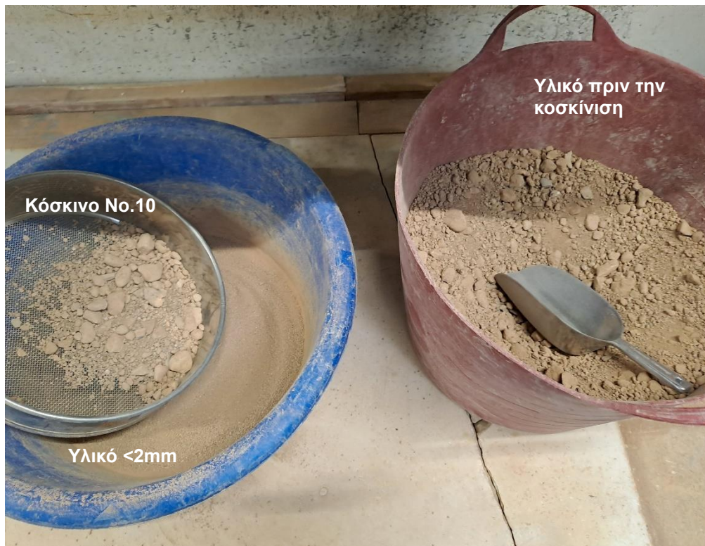
Σχήμα 4.8: Διαδικασία κοσκίνισης χονδρόκοκκου υλικού από το κόσκινο No.10 (<2mm)
