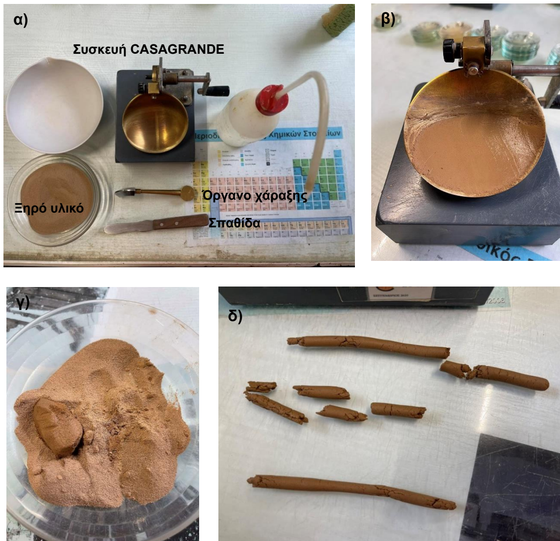
Σχήμα 4.5: α) Εξοπλισμός προσδιορισμού ορίου υδαρότητας β) Έδαφος έτοιμο προς χάραξη γ) Βώλος έτοιμος για κυλινδρισμό δ) Ραβδίσκοι που αρχίζουν να θρυμματίζονται, όριο πλαστικής κατάστασης
