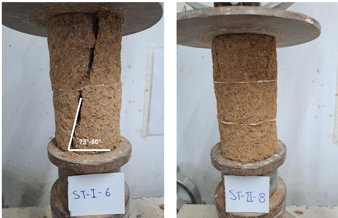
Σχήμα 5.1: Αριστερά: Δοκίμιο με μια στρώση γεωυφάσματος Δεξιά: Δοκίμιο με δυο στρώσεις γεωυφάσματος
