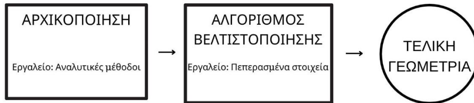
Σχήμα 3.11 : Διάγραμμα ροής της σχεδίασης του κινητήρα
