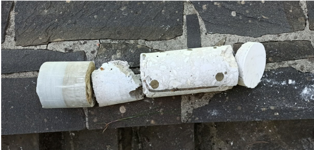
Εικόνα 4.18: Δοκίμιο από τοιχοποιία κτιρίου ξενώνα στο ΜΕ.Κ.Δ.Ε.
