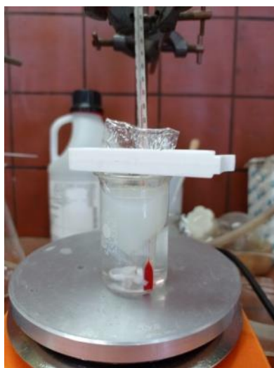
Εικόνα 26: Πειραματική διάταξης μελέτης της in vitro απελευθέρωσης των αντηλιακών φίλτρων σε υδατικό μέσο με τη χρήση μεμβράνης
