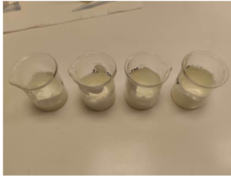
Εικόνα 27: Εμπορικό αντηλιακό σκεύασμα με ενσωματωμένη τη διασπορά των νανοδομημένων λιπιδικών φορέων όπου έχουν εγκλωβιστεί τα αντηλιακά φίλτρα
