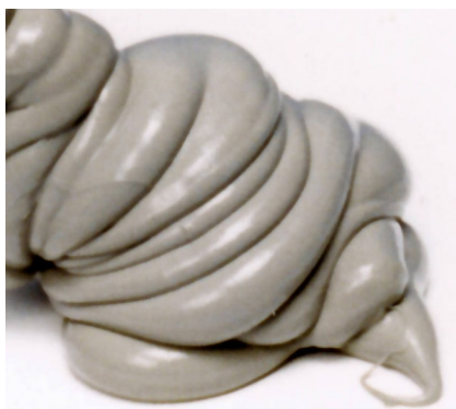
Εικόνα 3.2.2: Σιλικόνη που χρησιμοποιείται σε γωνίες για να εμποδίζει την είσοδο στην υγρασία [112]
