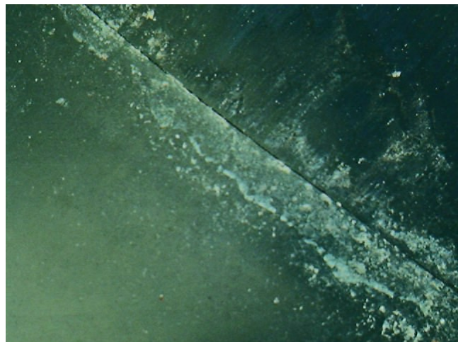
Εικόνα 7.1.11: Λήψη με φορητό ψηφιακό οπτικό μικροσκόπιο μικρορηγματώσεων στο γυαλί μαζί με αποθέσεις καφέ – μαύρου χρώματος (αριστερά) και αποθέσεις λευκού χρώματος (δεξιά) ( x50 ).
