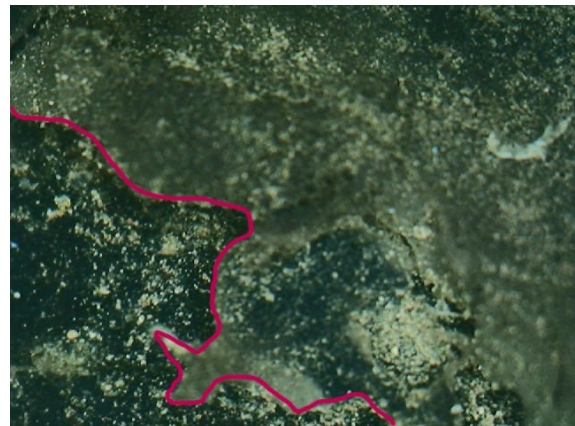
Εικόνα 7.1.4: Λήψη με φορητό ψηφιακό οπτικό μικροσκόπιο λευκών επικαθίσεων και υπολειμμάτων σιλικόνης στη γυάλινη επιφάνεια ( x50 ) (αριστερά) και καφέ επικαθίσεων και σιλικόνης κολλημένης στο κάτω μέρος της επιφάνειας ( x30 ) (δεξιά)
