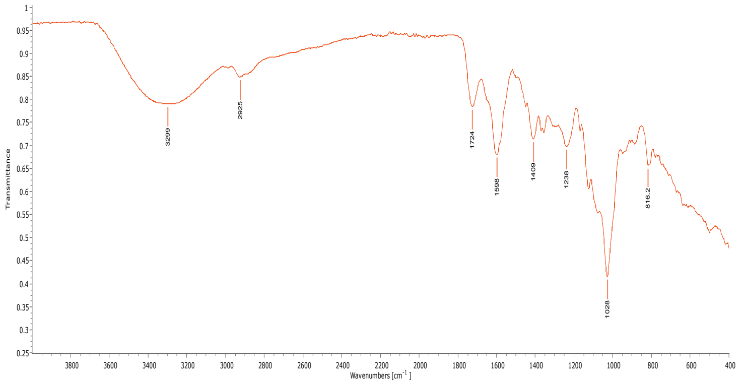
Διάγραμμα 25 : Φάσμα ATR/FT – IR του blank ( αλγινικό με NADES χωρίς τον εγκλωβισμό της χρυσίνης)
