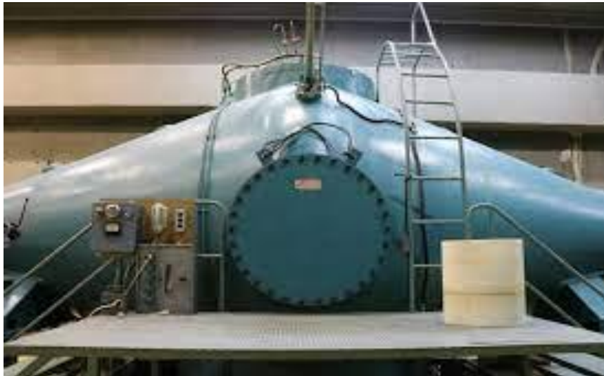
Σχήμα 3.1: Επιταχυντής 5.5MV Van de Graff Tandem του Ινστιτούτου Πυρηνικής Φυσικής του Ε.Κ.Ε.Φ.Ε. "Δημόκριτος".
