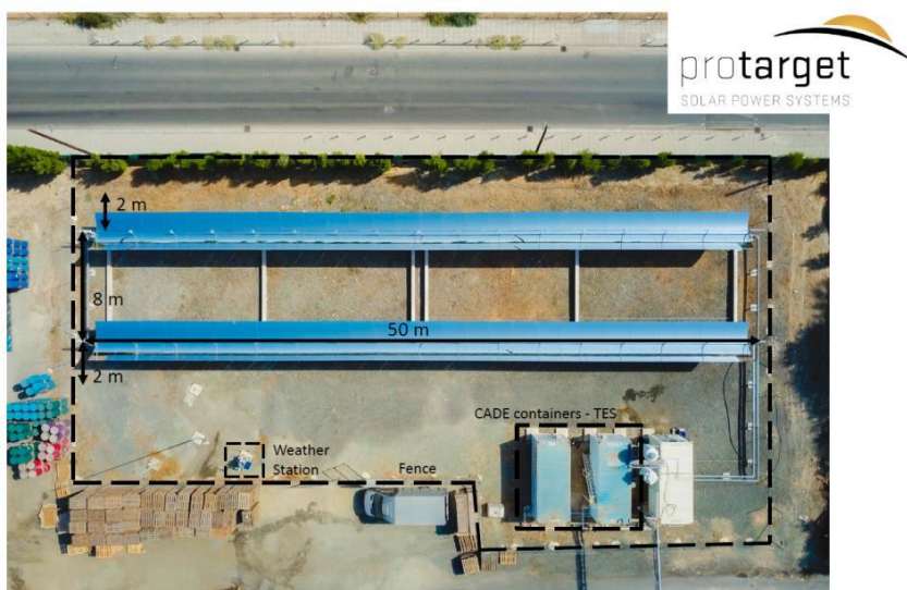
Σχήμα 30 : Κάτοψη του πεδίου ηλιακών συλλεκτών, των containers αποθήκευσης θερμότητας και του μετεωρολογικού σταθμού
