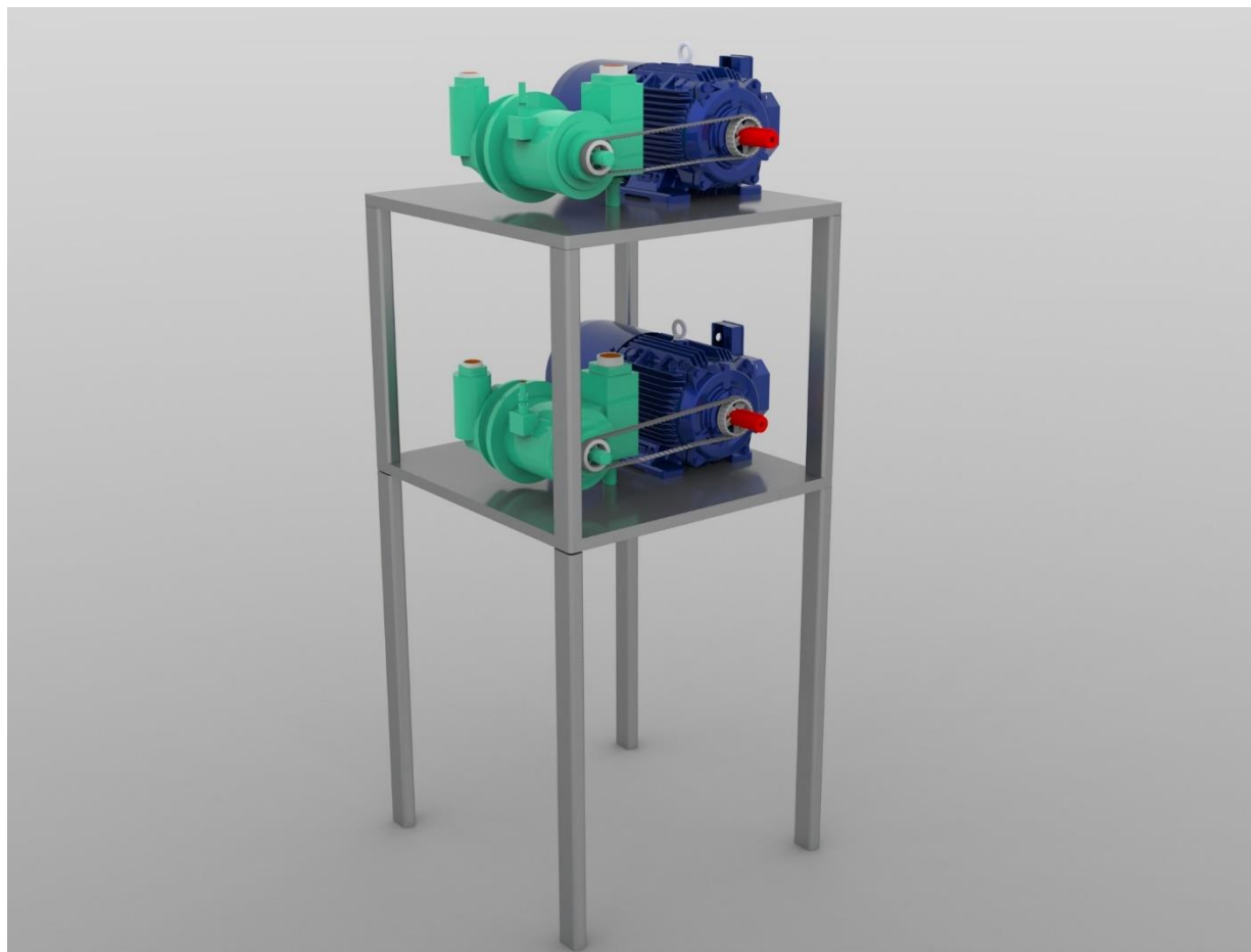
Σχήμα 49 : Υποσύστημα δύο εκτονωτών-γεννητριών με πλαίσιο στήριξης
