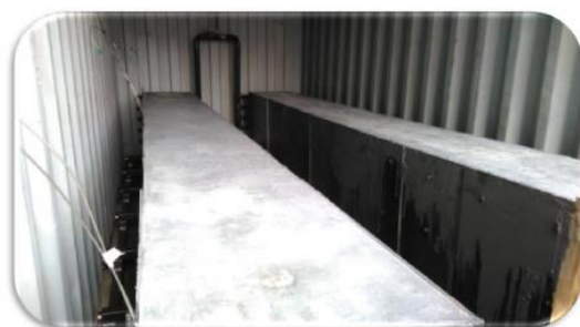
Σχήμα 33 : Εξωτερική άποψη και το περιεχόμενο των containers που θα στεγάσουν το σύστημα αποθήκευσης θερμότητας στερεής κατάστασης
