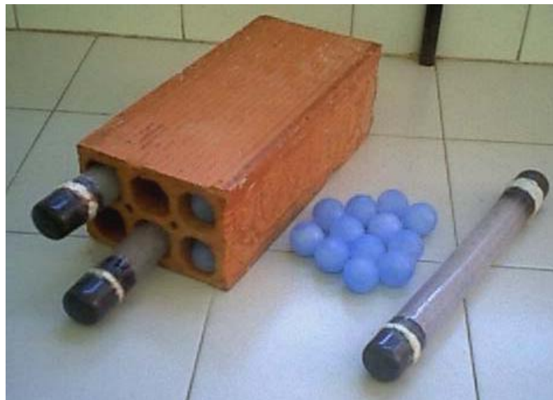
Σχήμα 6.4: Τούβλα με PCM σε κυλινδρικά δοχεία [40]
