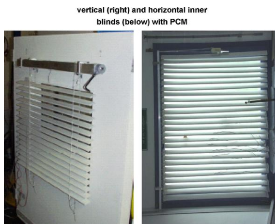
Σχήμα 6.8: Εφαρμογή PCM στην εσωτερική σκίαση υαλοπινάκων [3]
