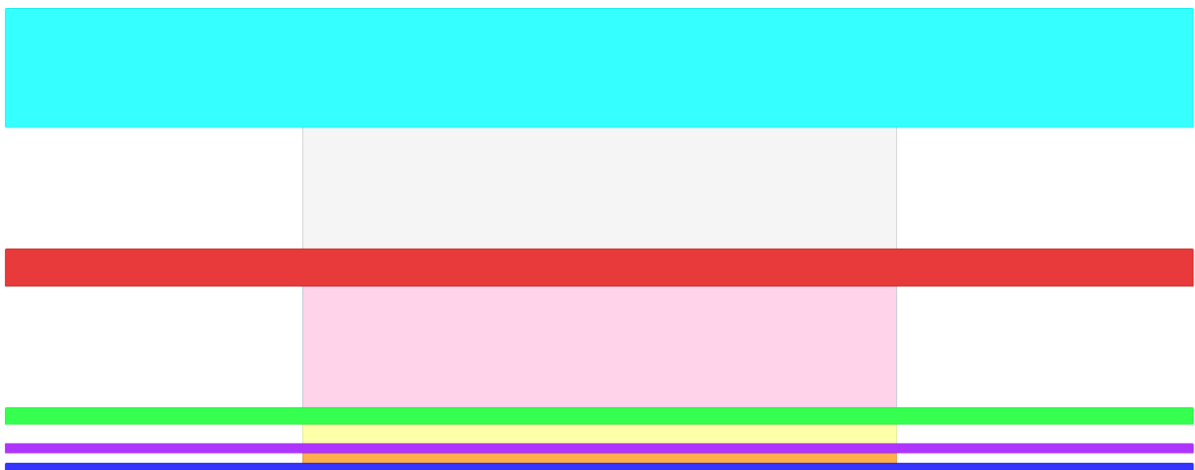
Εικόνα 37. Το 5LM Stack-up της τεχνολογίας IBM BiCMOS 90 nm
