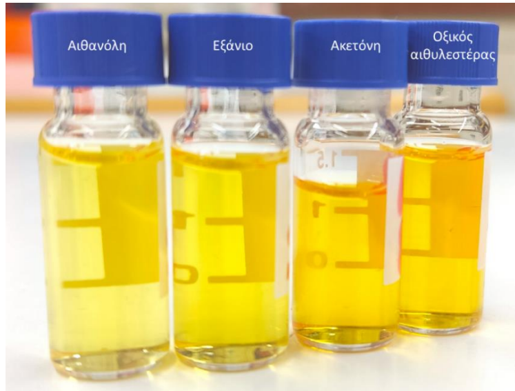
Εικόνα 6.3. Εκχυλίσματα τσίπουρου τομάτας έπειτα από εκχύλιση υποβοηθούμενη με Υπερυψηλή Πίεση σε αναλογία στερεού-υγρού 1:10 g/mL και πίεση 450 MPa
