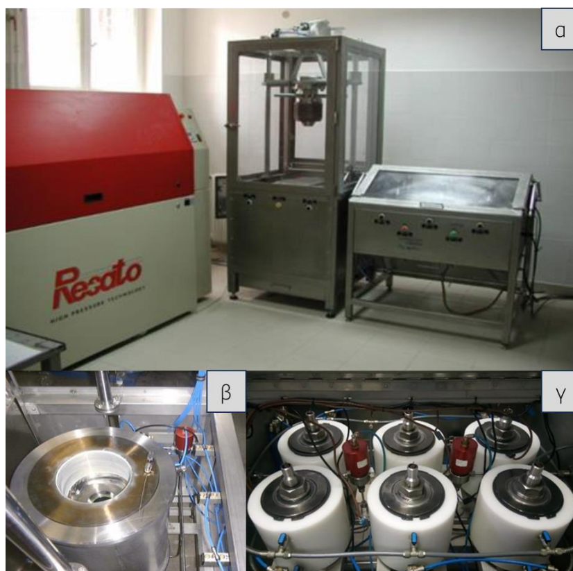
Εικόνα 5.2. α) Μονάδα Υπερυψηλής Πίεσης β) Μεγάλο δοχείο πίεσεως γ) Η συστοιχία των 6 μικρών δοχείων πίεσεως
