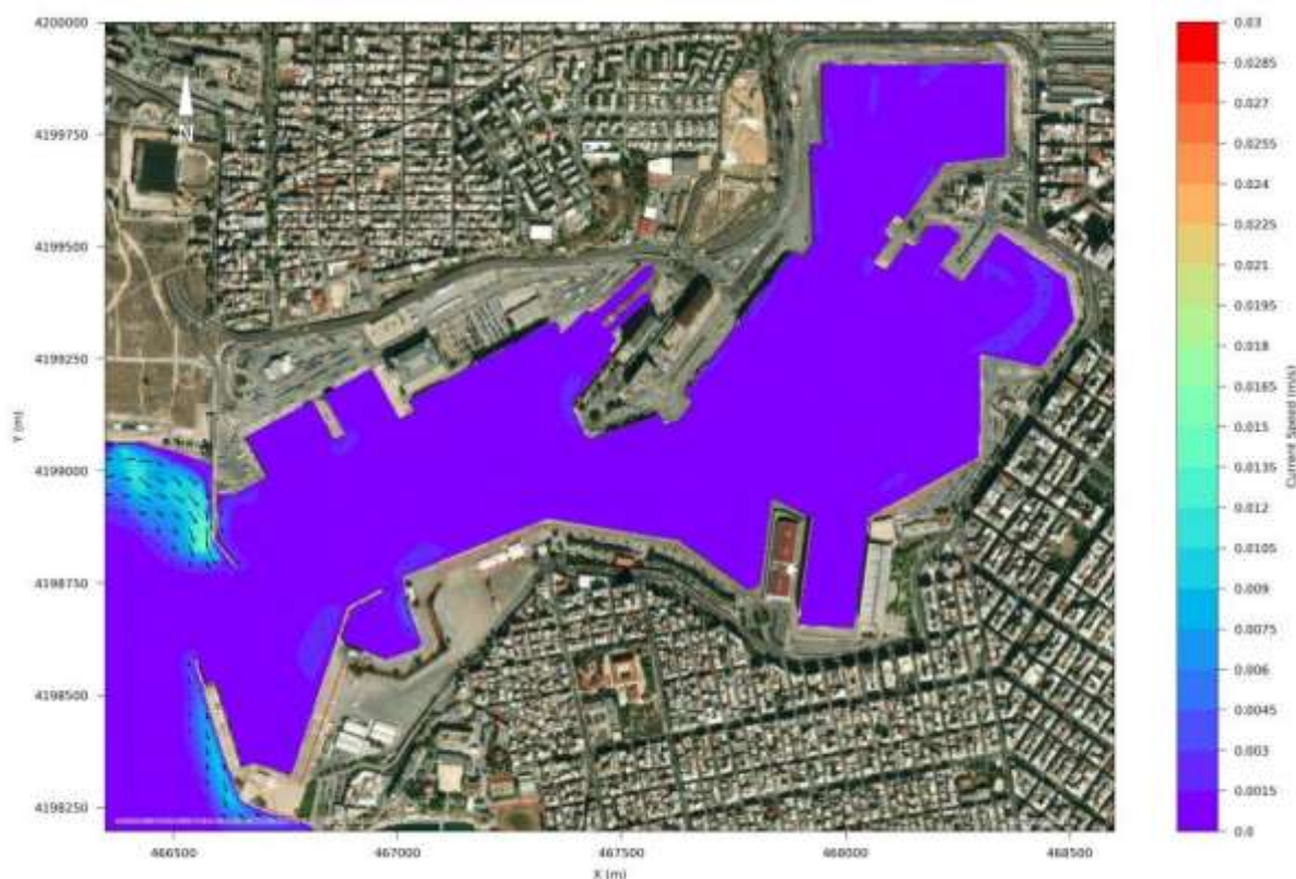
Εικόνα 4.5. Βόρειος άνεμος 0^\circ , 3 Bf – Χάρτης ταχυτήτων και διευθύνσεων ρεύματος εντός της λιμενολεκάνης
