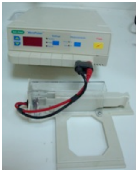
Εικόνα 2.4 Η συσκευή ηλεκτροδιάτρησης που χρησιμοποιήθηκε για το μετασχηματισμό των κυττάρων P. pastoris .
