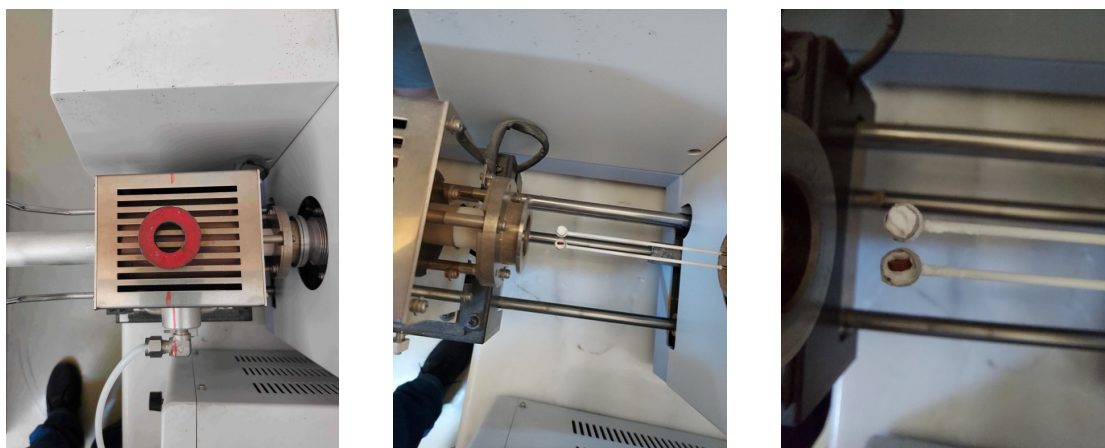
Σχήμα 4.4: Φωτογραφίες από την πειραματική διάταξη. Αριστερά, φαίνεται ο δακτυλιοειδής μαγνήτης που δημιουργεί το εξωτερικό πεδίο.
