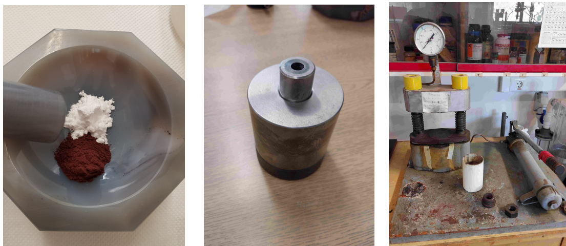
Σχήμα 3.3: Πριν πραγματοποιηθεί η θερμική κατεργασία των δειγμάτων, τα αντιδραστήρια αναμειγνύονται και συμπιέζονται.
