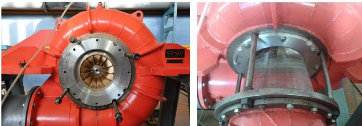
Εικόνα 7.39. Εργαστηριακό μοντέλο κατόπιν κατασκευής και εγκατάστασης νέων τεμαχίων και νέου δρομέα.
