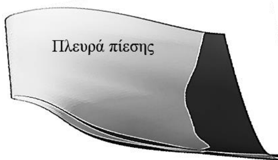
Εικόνα 7.25. Σύγκριση αρχικής (γκρι) και τελικής γεωμετρίας (μαύρο).
