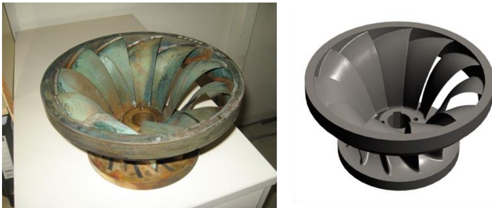
Εικόνα 4.5. (Αριστερά) Δρομέας υδροστροβίλου Francis εργαστηριακού μοντέλου και (Δεξιά) ο ψηφιοποιημένος δρομέας που προέκυψε ύστερα από την σάρωση και ανακατασκευή της γεωμετρίας με χρήση τεχνικών CAD.
