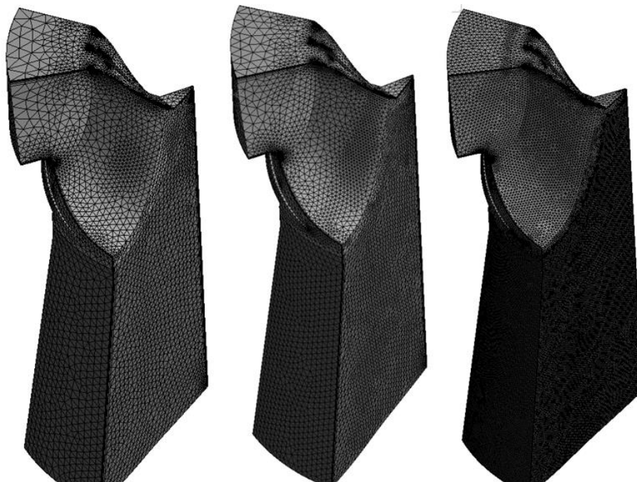
Εικόνα 5.5. Σταδιακή πύκνωση πλεγμάτων.
