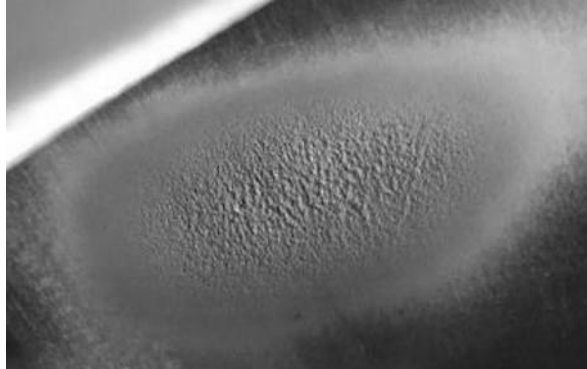
Εικόνα 2.27. Τυπική φθορά λόγω σπηλαιώσης σε δρομέα με την χαρακτηριστική ‘παγωμένη’ μορφή στην επιφάνεια του δρομέα.
