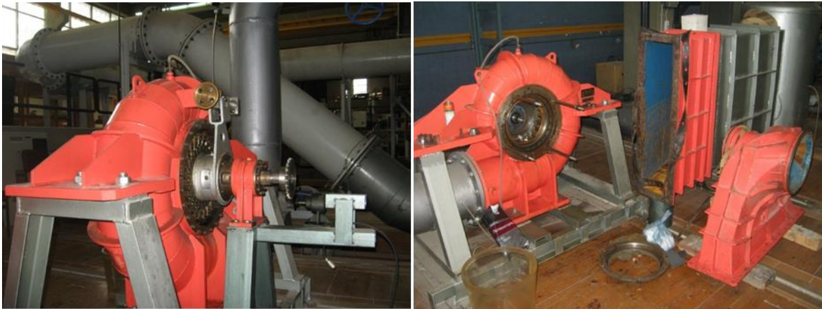
Εικόνα 4.3. Μοντέλο υδροστροβίλου Francis. (Αριστερά) Διάταξη ρύθμισης του ανοίγματος των ρυθμιστικών πτερυγίων και (Δεξιά) Αποσυναρμολόγηση μοντέλου για τις ανάγκες ψηφιοποίησης της γεωμετρίας και των διαστατικών μετρήσεων.
