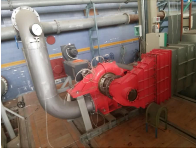
Εικόνα 4.1. Μοντέλο υδροστροβίλου Francis εγκατεστημένο στο Εργαστήριο Υδροδυναμικών Μηχανών.
