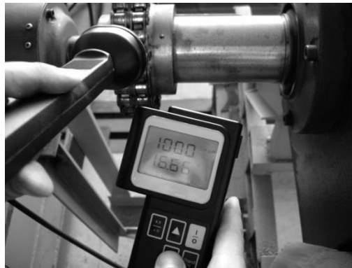
Εικόνα 4.19. Χρήση στροβοσκοπίου για την μέτρηση της ταχύτητας περιστροφής της ατράκτου.
