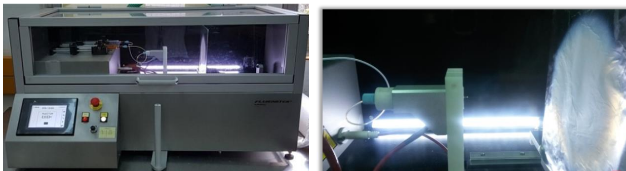
Εικόνα 11. Διάταξη ηλεκτρο-υδροδυναμικής διεργασίας (αριστερά) και πείραμα σε λειτουργία (δεξιά).
