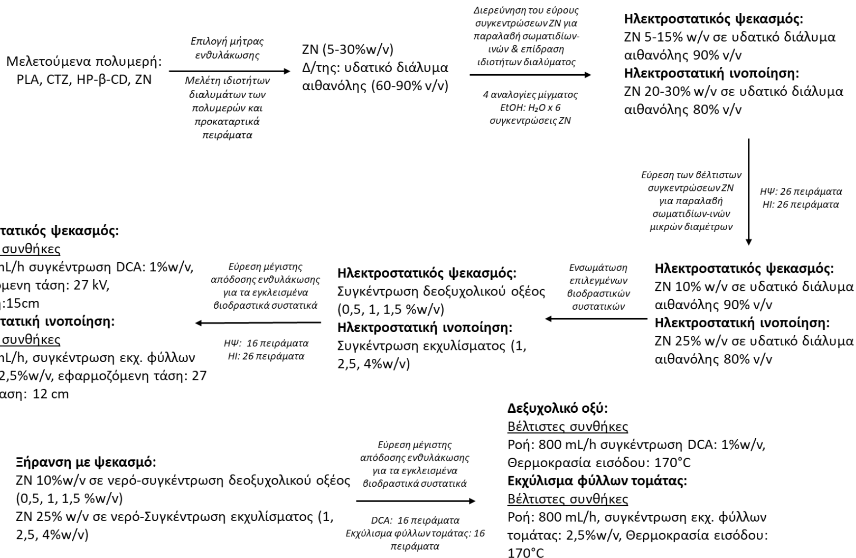
Σχήμα 26 Σχηματική απεικόνιση των πειραματικών δοκιμών που πραγματοποιήθηκαν για την παραλαβή των βέλτιστων προϊόντων ενθυλάκωσης του δεοξυχολικού οξέος και του εκχυλίσματος φύλλων τομάτας.
