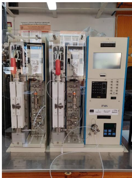
Εικόνα 7 Διάταξη εκχύλισης με χρήση πεπιεσμένου υγρού (PLE)
