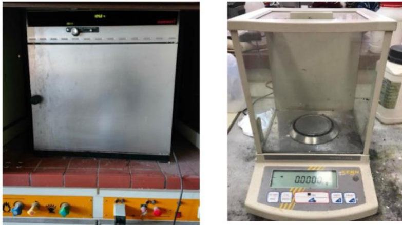
Εικόνα 28. Φούρνος σταθερής θερμοκρασίας 105 °C (αριστερά), αναλυτικός ζυγός δεξιά.
