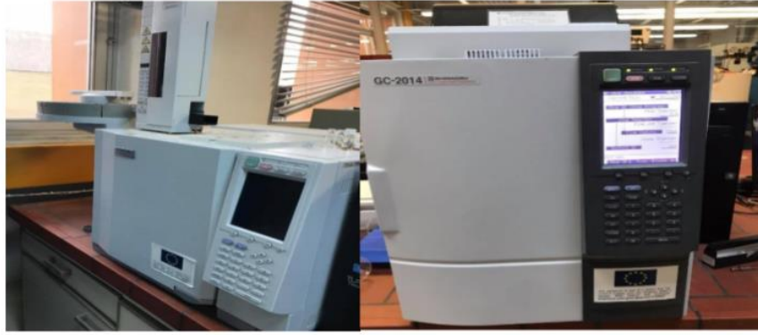
Εικόνα 30. Χρωματογράφος Shimadzu GC-2010 (αριστερά), χρωματογράφος Shimadzu GC 2014 (δεξιά).
