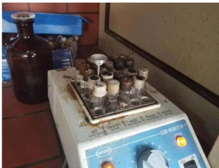
Εικόνα 29. Ειδικός φούρνος στους 150°C για την εξώθερμη αντίδραση μέτρησης των COD.
