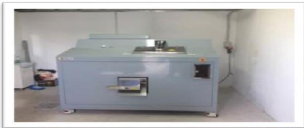
Εικόνα 21. Ξηραντήρας όπου έλαβε χώρα η ξήρανση και ο τεμαχισμός των τροφικών υπολειμμάτων.
