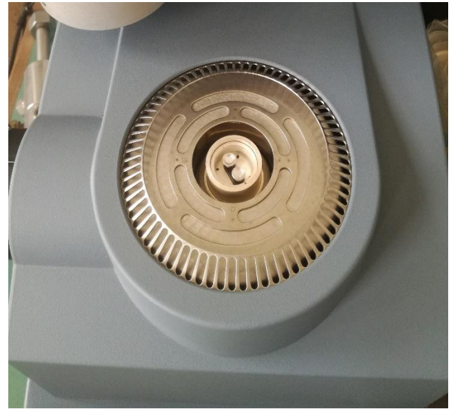
Εικόνες 4.2.1α, β: Διάταξη Q200 διαφορικής θερμιδομετρίας σάρωσης, εξωτερικά με τα καψίδια που χρησιμοποιούνται και εσωτερικά με τις κυψελίδες
