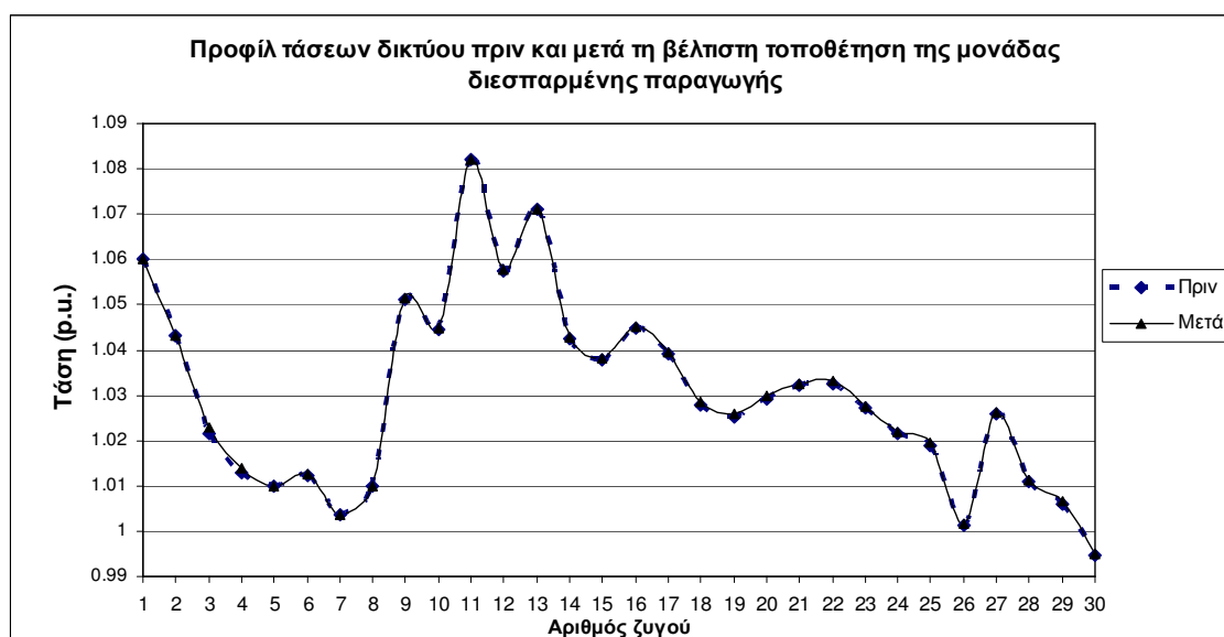
Σχήμα 8.28: Προφίλ τάσεων των ζυγών του δικτύου 30 ζυγών της IEEE πριν και μετά τη βέλτιστη τοποθέτηση της μονάδας διεσπαρμένης παραγωγής 15 MW.
