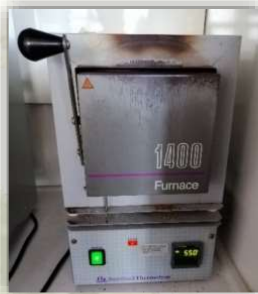
Σχήμα 5.1: Φούρνος μέτρησης πτητικών στερεών
