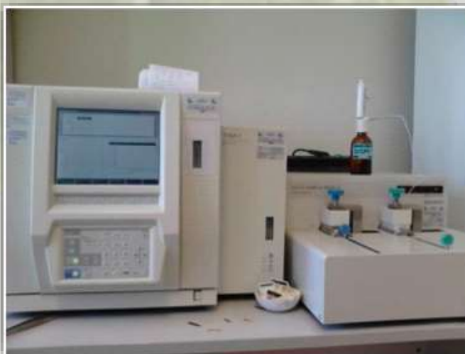
Σχήμα 5.2 : Συσκευή μέτρησης TOC.
