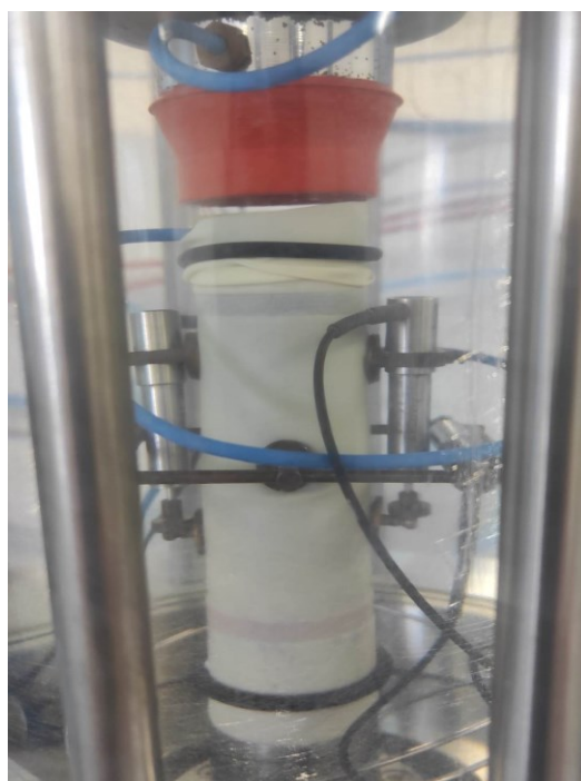
Σχήμα 3.5: Σύνδεση δοκιμίου με το αξονικό έμβολο για την επιβολή εφελκυστικής/ανακυκλικής φόρτισης. Μετρητές αξονικής παραμόρφωσης επί του δοκιμίου (LVDTs) και τοπικού μετρητή πλευρικής παραμόρφωσης (radial strain belt)
