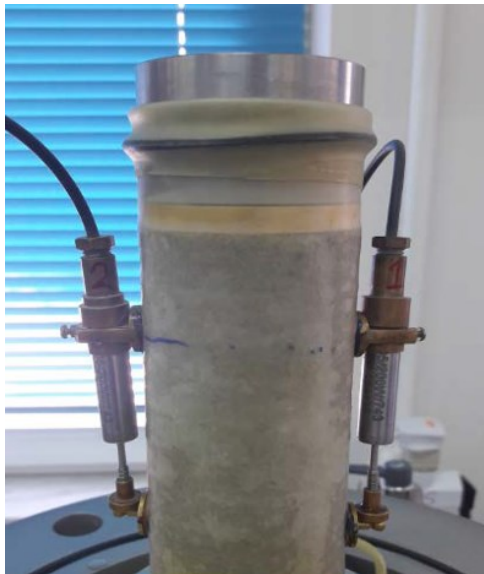
Σχήμα 3.3: Μετρητές αξονικής παραμόρφωσης επί του δοκιμίου (LVDTs)
