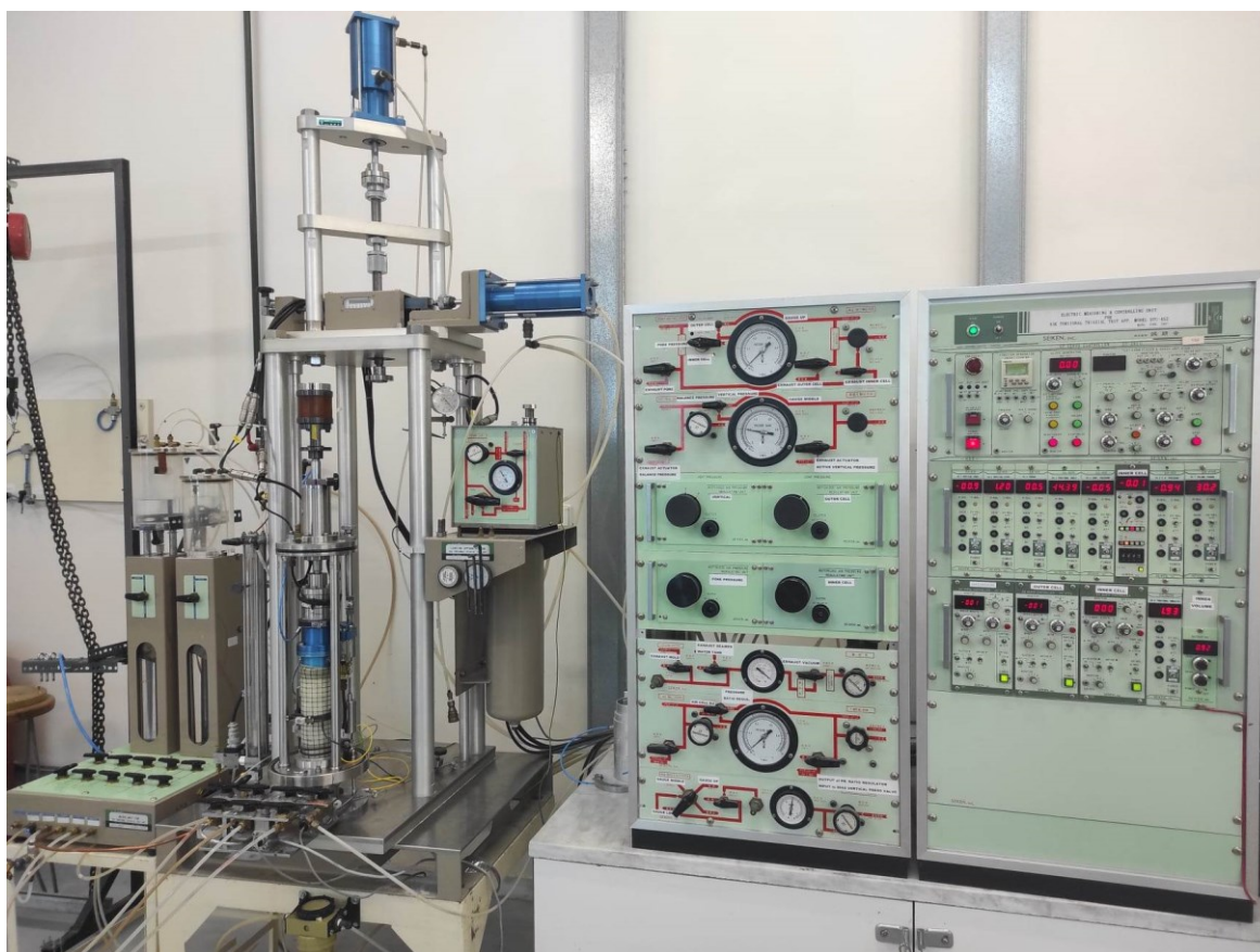
Σχήμα 3.6: Συσκευής στρεπτικής διάτμησης κούλου δοκιμίου του εργαστηρίου Εδαφομηχανικής ΕΜΠ
