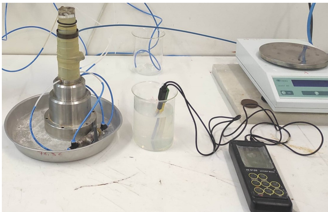
Σχήμα 3.14: Υγρόλυμα κολλοειδούς πυριτίας πριν τοποθετηθεί στο ειδικά διαμορφωμένο καλούπι για την παρασκευή του σταθεροποιημένου δοκιμίου
