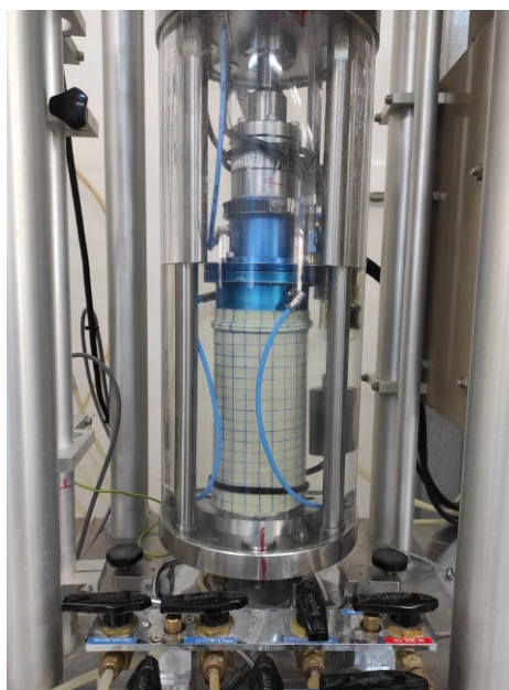
Σχήμα 3.7: Τριαξονική κυψέλη της συσκευής στρεπτικής διάτμησης κούλου δοκιμίου του εργαστηρίου Εδαφομηχανικής ΕΜΠ
