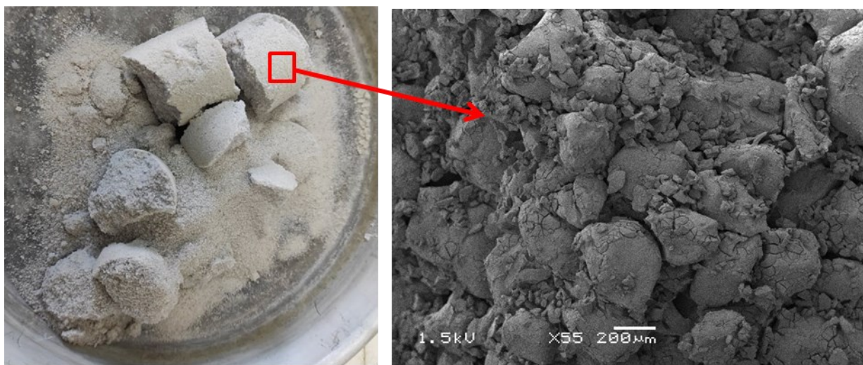
Σχήμα 3.16: Φωτογραφία και απεικόνιση από ηλεκτρονικό μικροσκόπιο σταθεροποιημένου δοκιμίου μετά από ξήρανση
