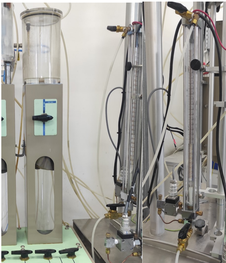
Σχήμα 3.9: Δεξαμενή πίεσης εσωτερικής κυψέλης (inner pressure tank) και προχοΐδα μέτρησης των μεταβολών όγκου της εσωτερικής κυψέλης (inner volume change burette)
