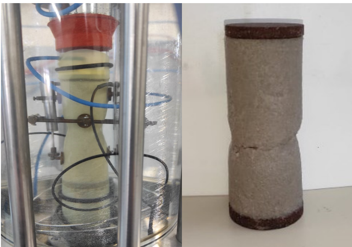
Σχήμα 4.19: Φωτογραφίες σταθεροποιημένου δοκιμίου άμμου M31: α) πριν την φόρτιση, β) μετά από τριαξονική θλίψη και γ) μετά από τριαξονικό εφελκυσμό
