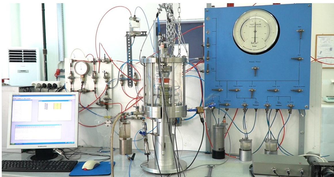
Σχήμα 3.4: Τριαξονική συσκευή (Bishop & Wesley, 1975) του εργαστηρίου Εδαφομηχανικής ΕΜΠ
