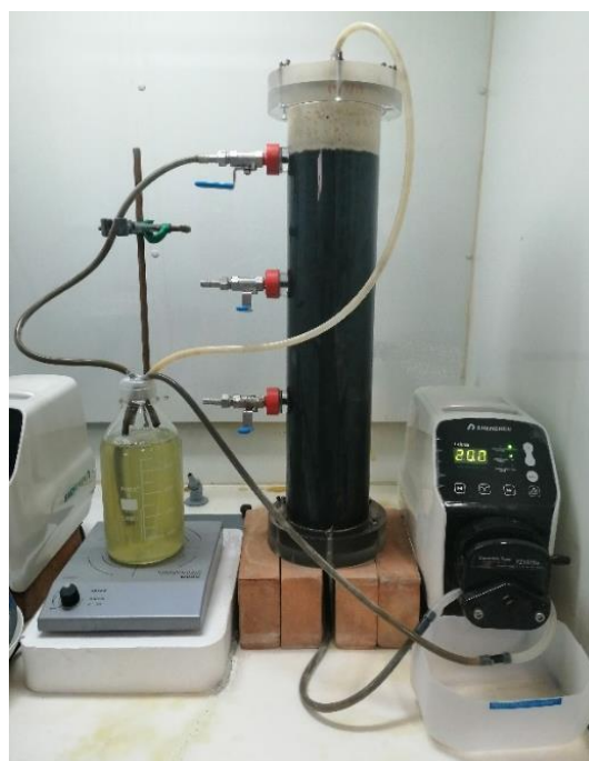
Εικόνα 4.1: (α) Σχηματική απεικόνιση του βιοαντιδραστήρα: (1) εισροή από τον αντιδραστήρα πλήρους ανάμιξης (CSTR), (2) περισταλτική αντλία, (3) αντιδραστήρας σταθερής κλίνης, (4) εκροή αντιδραστήρα, (5) & (6) θύρες δειγματοληψίας και (7) στόμιο εξαερισμού, και (β) ο απονιτροποιητικός βιολογικός αντιδραστήρας σε εργαστηριακή κλίμακα
