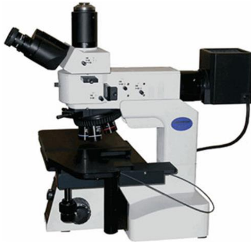
Σχήμα 2. 4. Οπτικό μικροσκόπιο OLYMPUS MX51 INDUSTRIAL MICROSCOPE στις εγκαταστάσεις του Εργαστηρίου Καθαρού Χώρου του Ι.Ν.Ν., Ε.Κ.Ε.Φ.Ε. «Δημόκριτος».
