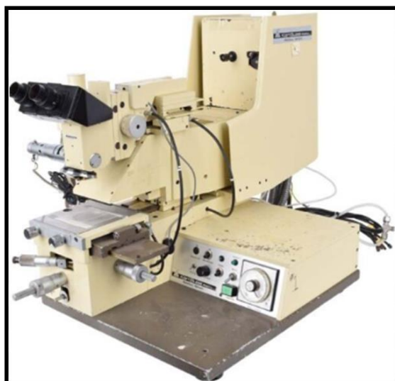
Σχήμα 2. 1. Ο ευθυγραμμιστής μασκών Karl-Suss MJB 3 STD, του Εργαστηρίου Καθαρού Χώρου του Ινστιτούτου Νανοεπιστήμης και Νανοτεχνολογίας (I.N.N.) του Ε.Κ.Ε.Φ.Ε. «Δημόκριτος».
