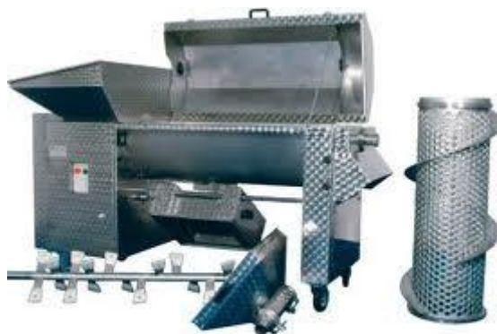
Σχήμα: Θλιπτήριο-εκραγιστήριο σε ενιαίο μηχάνημα
