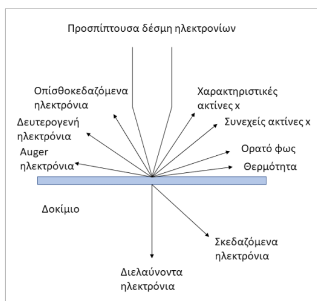
Εικόνα 4. 6. Φαινόμενα αλληλεπίδρασης δέσμης [3].
