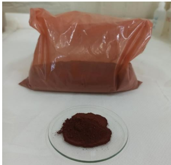
Εικόνα 6.3. Δείγμα του μεταλλεύματος μετά τις κατεργασίες θραύσης και λειοτριβίσης.
