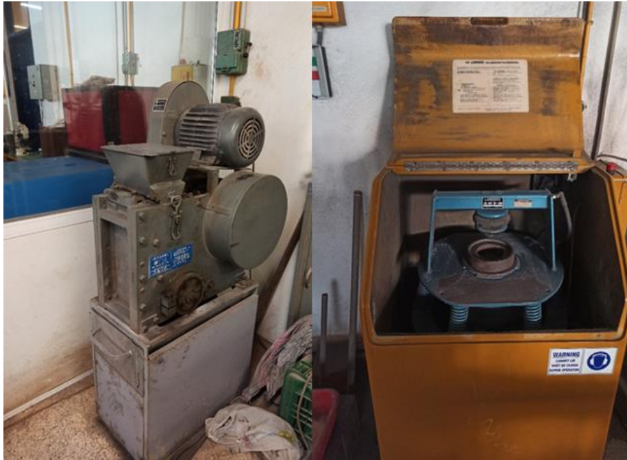
Εικόνα 6.2. Εργαστηριακός θραυστήρας σιαγόνων (αριστερά) και συσκευή Lab Technics LM2 Laboratory Pulverising Mill (δεξιά).
