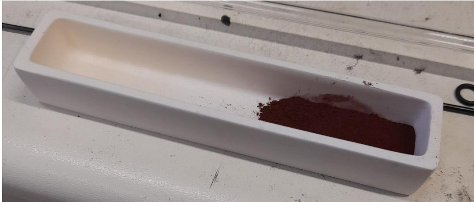
Εικόνα 6.5. Σκαφίδιο αλουμίνας με το προς αναγωγή υλικό
