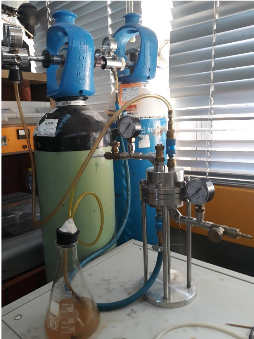
Εικόνα 14: Συσκευή που χρησιμοποιήθηκε για τη μέτρηση της διαπερατότητας οξυγόνου εδώδιμων μεμβρανών.
