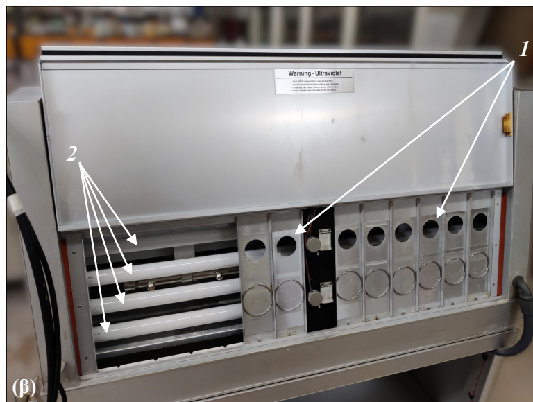
Εικόνα 3(α,β). (α) αρχικοί δειματοφορείς 2 θέσεων δοκιμίων, (β) εσωτερικό συσκευής ΠΕΓ: (β/1) 2+6 κενοί δειματοφορείς μονής θέσης δοκιμίου στην πρόσθια ανοιχτή πλευρά του οργάνου, (β/2) 4 λαμπτήρες UV-313B ορατοί από τις 4 ελεύθερες θέσεις δειματοφορέων [φωτ/φίες: Γ. Παπαλάμπρης]
