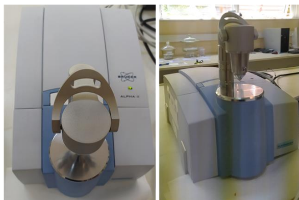
Figure 22. Spectrometer Platinum-ATR ALFA II Bruker
