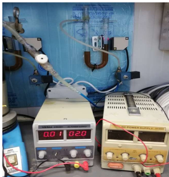
Σχήμα 21. Τροφοδοτικό συνεχούς ρεύματος "DC Power Supply PS 1502DD" και μετρητής όγκου βιοαερίου (κλικογράφος)
