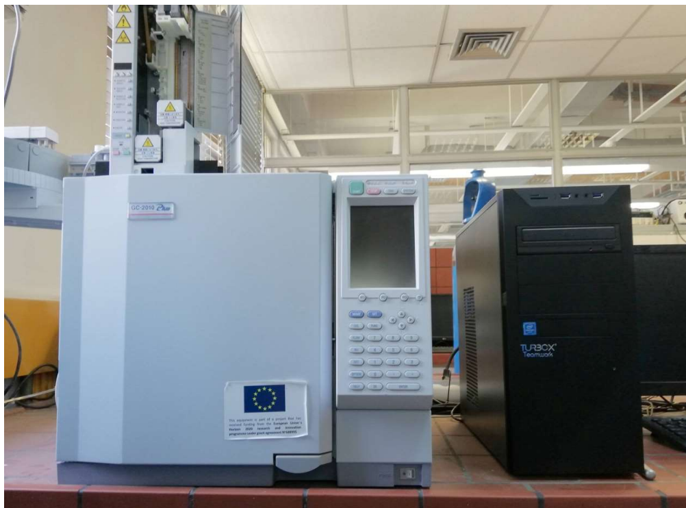
Σχήμα 32. Αέριος χρωματογράφος Shimadzu GC-2010 plus με ανιχνευτή φλόγας ιονισμού (FID)
