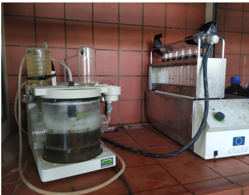
Σχήμα 34. Συσκευή χώνευσης δειγμάτων (δεξιά) και scrubber για την απομάκρυνση των όξινων αερίων της χώνευσης (αριστερά)
