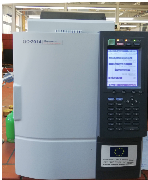
Σχήμα 31.Αέριος Χρωματογράφος Shimadzu GC-2014 με ανιχνευτή TDC για τον προσδιορισμό της σύστασης του βιοαερίου
