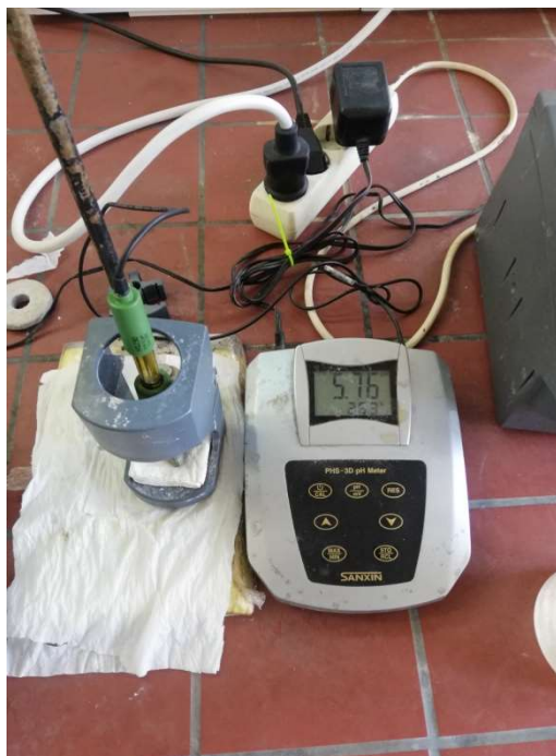
Σχήμα 24. Πεχόμετρο πάγκου "Sanxin PHS-3D-01 Lab pH Meter" και ηλεκτρόδιο "SensoDirect pH electrode type 330"
