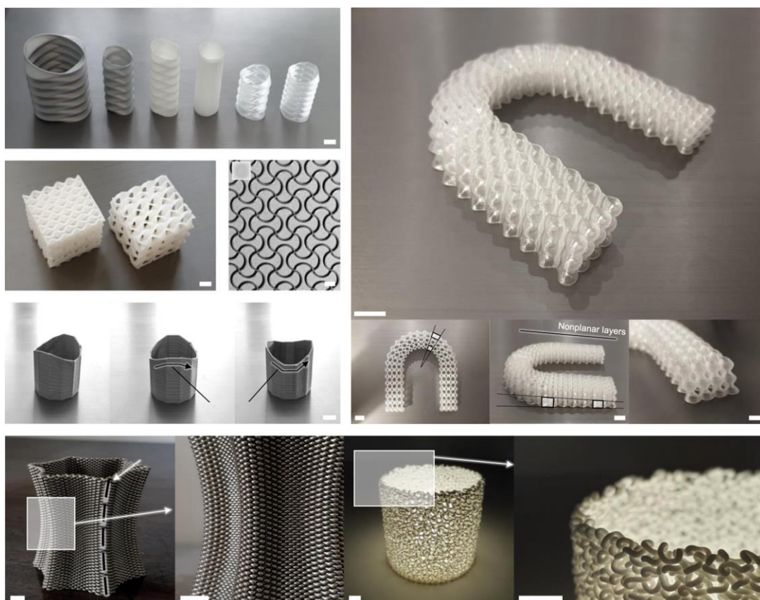
Σχήμα 12. Δομές που έχουν δημιουργηθεί με μαθηματικές συναρτήσεις μέσω FullControl
