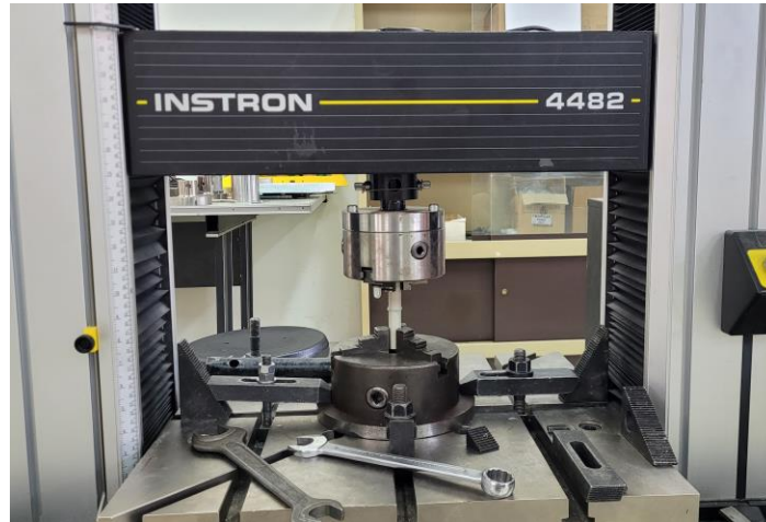
Εικόνα 18. Μηχανή δοκιμής αντοχής σε εφελκυσμό
