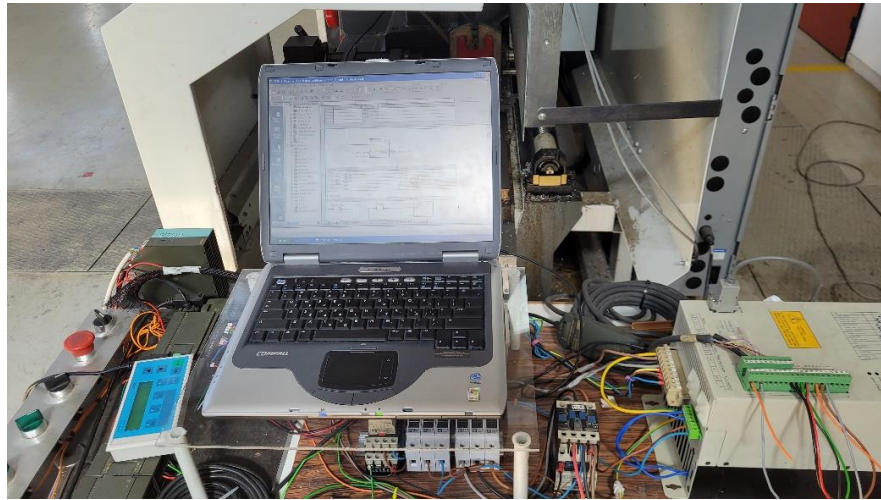
Εικόνα 2. Προγραμματισμός PLC με ηλεκτρονικό υπολογιστή
