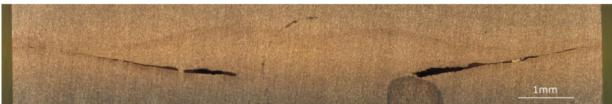
Εικόνα 24. Πανοραμική φωτογραφία επιφάνειας συγκόλλησης των τεμαχίων αλουμινίου
