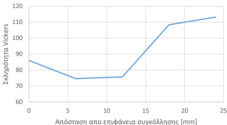
Σχήμα 26. Μεταβολή της σκληρότητας στην επιφάνεια του τεμαχίου από αλουμίνιο
