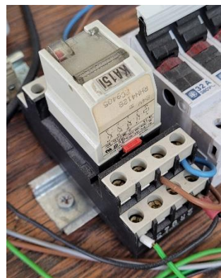
Εικόνα 15. Ρελέ ελέγχου παροχής ρεύματος (κύριας αριστερά, βοηθητικής δεξιά)
