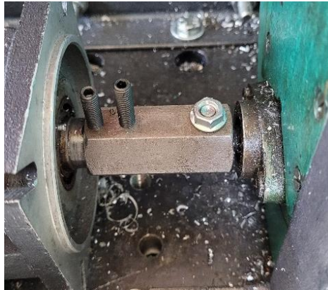
Εικόνα 12. Σύνδεσμος άξονα κινητήρα – μειωτήρα
