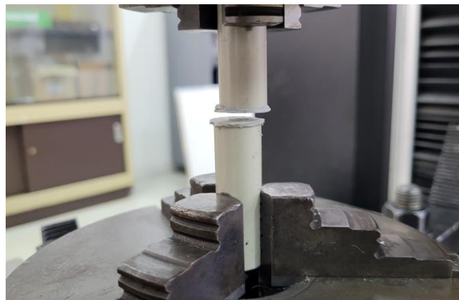
Εικόνα 19. Αστοχία δοκιμίου PVC σε δοκιμή εφελκυσμού
