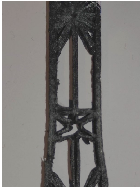
Εικόνα 30: Απεικόνιση αποκόλλησης ινών
