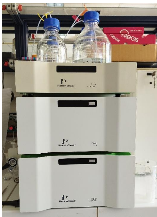
Σχήμα 16. Σύστημα υγροχρωματογραφίας Flexar (Perkin Elmer).
