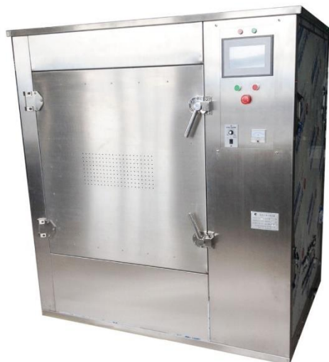
Σχήμα 3.4: Εξοπλισμός ζεματίσματος με μικροκύματα
