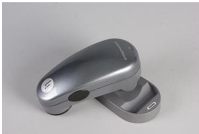
Σχήμα 4.12: Χρωματόμετρο Eye One (GretagMacbeth)
