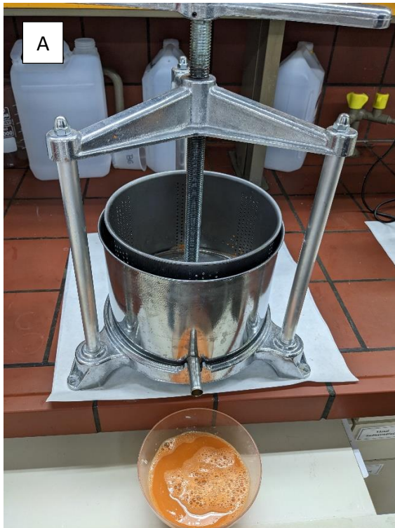
Σχήμα 4.6: (Α): Χυμοποίηση καρότου με πρέσα (Β):Θερμική προ επεξεργασία καρότου
