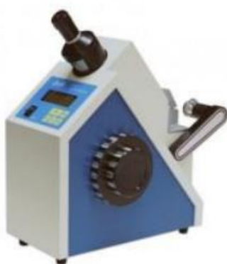
Σχήμα 4.8: Διαθλασίμετρο με το οποίο μετρήθηκαν τα ολικά διαλυτά στερεών (°Bx) των χυμών
