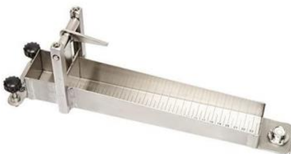
Σχήμα 4.10: Όργανο μέτρησης της συνεκτικότητας κατά Bostwick (Bostwick Consistometer, Extended Length, 30 cm)
