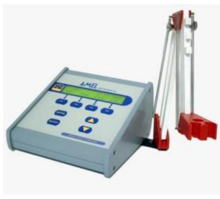
Σχήμα 4.9: Ηλεκτρονικό pH-μετρο (pHmeter 338, Amel instruments, Milan, Italy)
