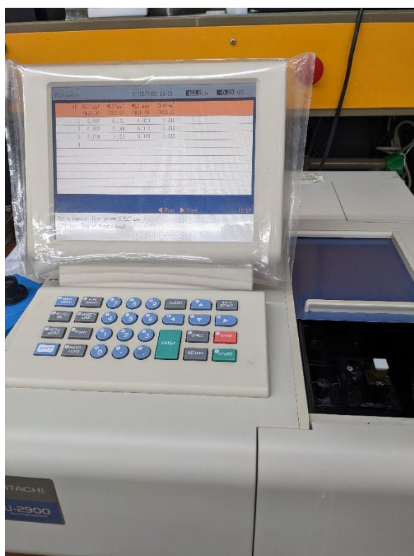
Σχήμα 4.15: Φασματοφωτόμετρο Hitachi U-2900 το οποίο χρησιμοποιήθηκε για τον προσδιορισμό των καρτενοειδών σε χυμό καρότου
