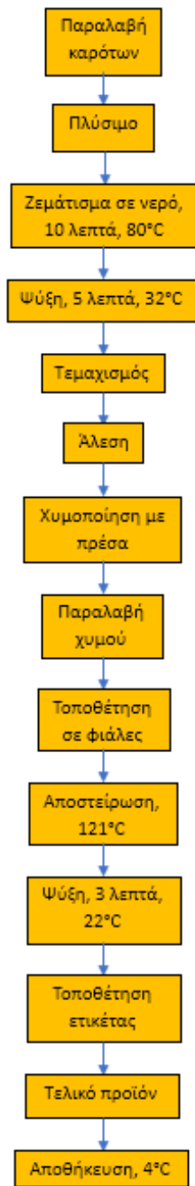
Σχήμα 2.3: Διάγραμμα ροής χυμοποίησης καρότου στη βιομηχανία
