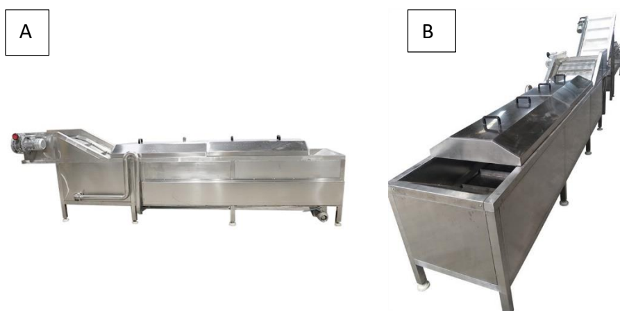
Σχήμα 3.3: (Α): Εξοπλισμός που χρησιμοποιείται για ζεμάτισμα με ατμό (Β): Εξοπλισμός που χρησιμοποιείται για ζεμάτισμα με εμβάπτιση σε νερό
