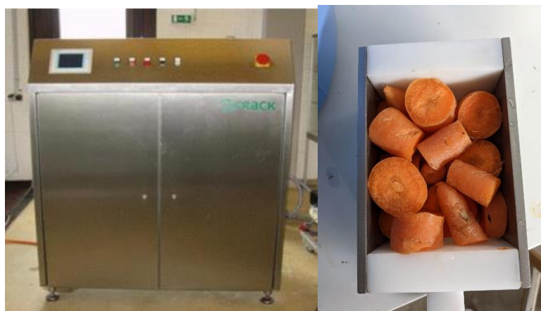
Σχήμα 4.2: Μονάδα παραγωγής Παλμικών Ηλεκτρικών Πεδίων και δίπλα ο θάλαμος επεξεργασίας
