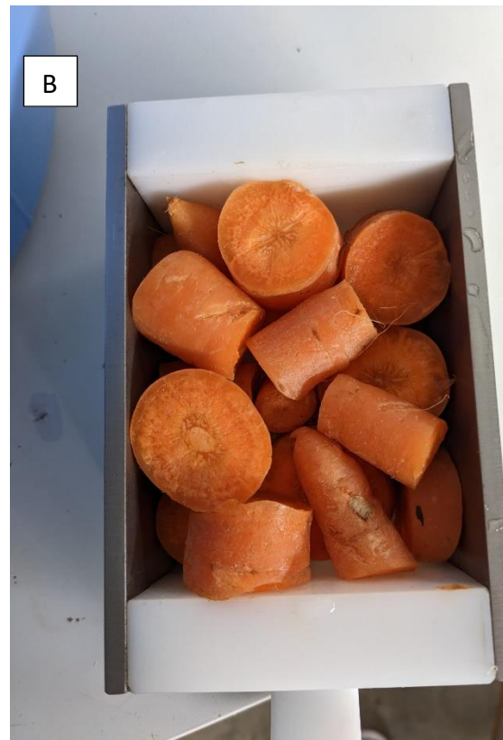
Σχήμα 4.7: (Α): Προ επεξεργασία αλεσμένου καρότου με ΠΗΠ (Β): Προ επεξεργασία καρότου σε ροδέλες με ΠΗΠ
