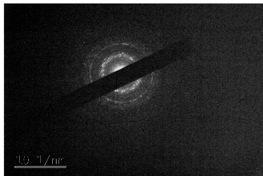
Εικόνα 30. Περίθλαση ηλεκτρονίων επιλεγμένης περιοχής SAED για την νανοκόνη ζιρκονίας (3Y-ZrO 2 -N).
