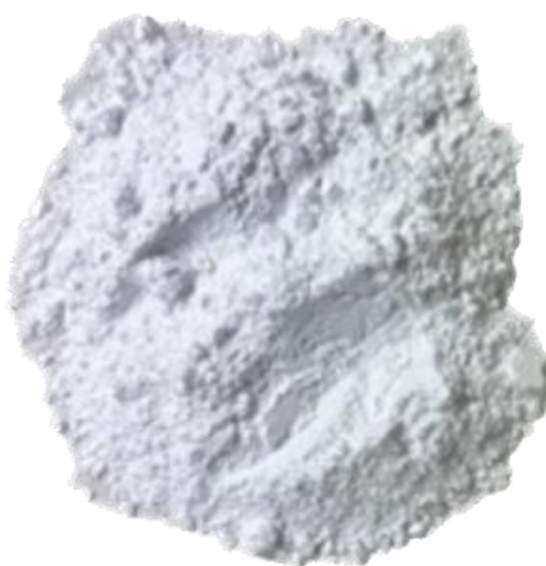
Εικόνα 27. Τελική μορφή νανοσκόνης 3Y-ZrO 2 -N.
