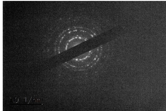
Εικόνα 35. Περίθλαση ηλεκτρονίων επιλεγμένης περιοχής SAED για την νανοσκόνη ζιρκονίας ( 3Y-ZrO_2-O ).
