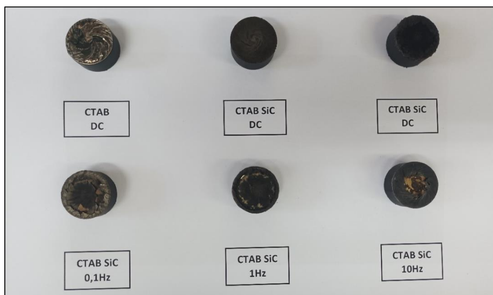
Εικόνα 3. 7. Φωτογραφίες δειγμάτων παρουσία CTAB και απουσία SDS.
