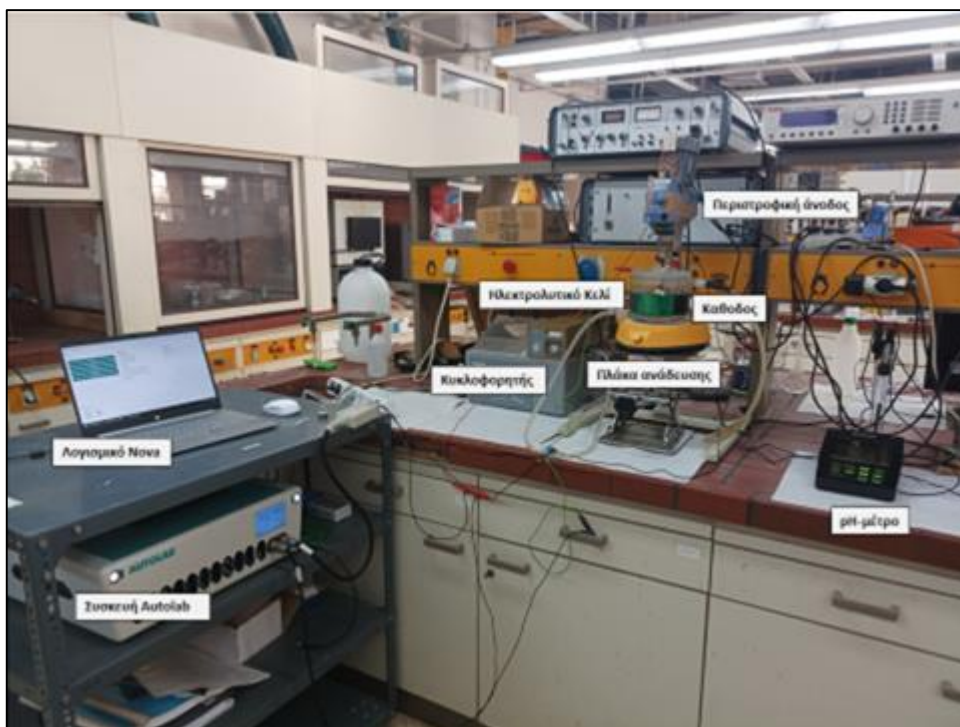
Εικόνα 3. 2. Πειραματική διάταξη με τη χρήση Autolab.
