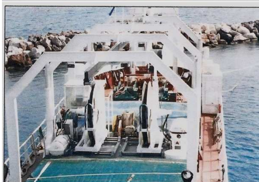
Εικόνα 4.28: Διάφορες λήψεις του CLV «ΙΚΑΡΟΣ» Διακρίνεται ο εξοπλισμός ποντίσεως καθώς και δύο τύμπανα αποθήκευσης καλωδίου
