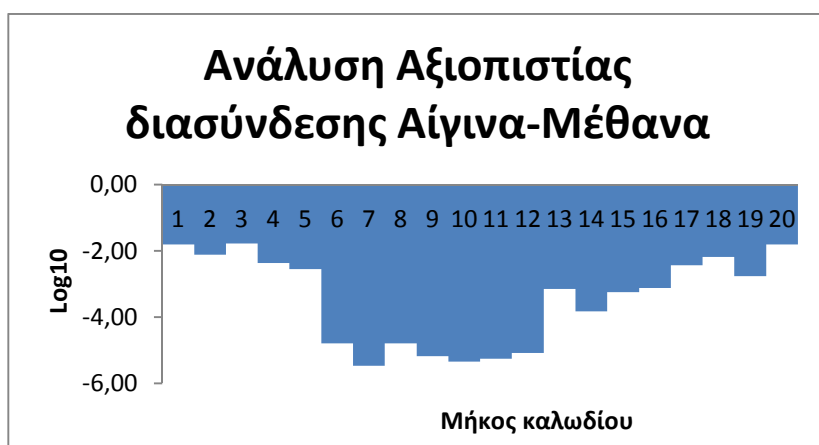
Σχήμα 6.11: Λογαριθμική ανάλυση αξιοπιστίας διασύνδεσης Αίγινα -Μέθανα
