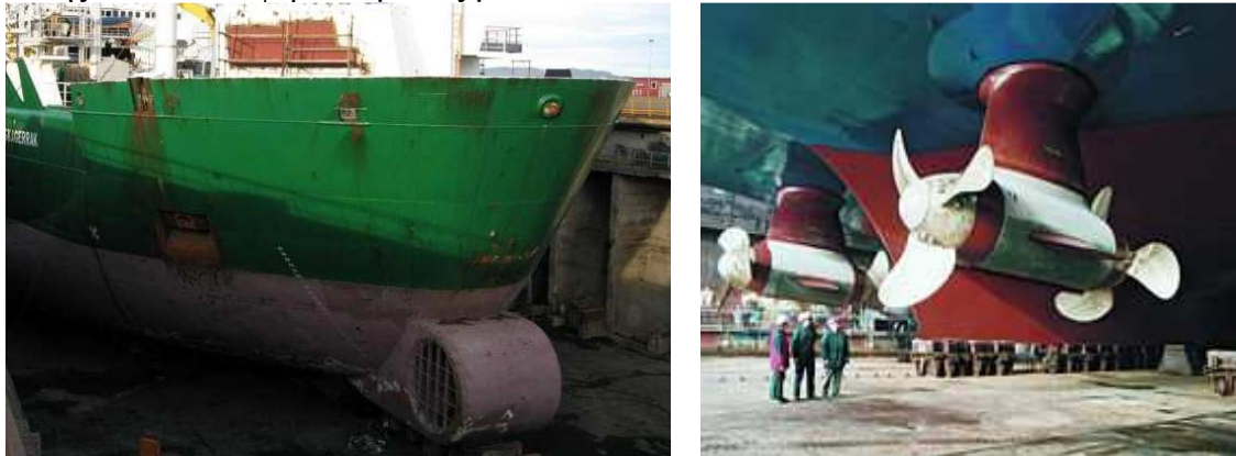
Εικόνα 4.7 : Δυναμικά συστήματα ακριβούς διατήρησης θέσης Αριστερά bow thruster, Δεξιά Azimuth pods
