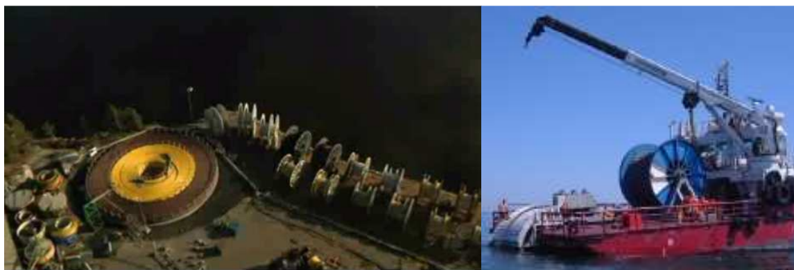
Εικόνα 4.4 :Αριστερά Μέσα αποθήκευσης καλωδίου, διακρίνεται περιστρεφόμενη τράπεζα, καρούλια διαφόρων μεγεθών. Δεξιά Κατακόρυφο περιστρεφόμενο τύμπανο αποθήκευσης καλωδίου
