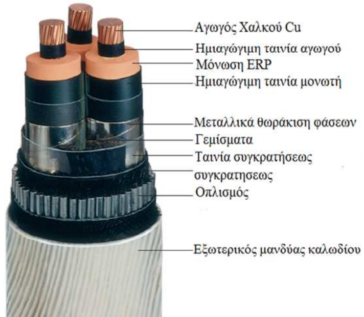
Εικόνα 2.6 : Υποβρύχιο καλώδιο MT με μονωτή από ERP
