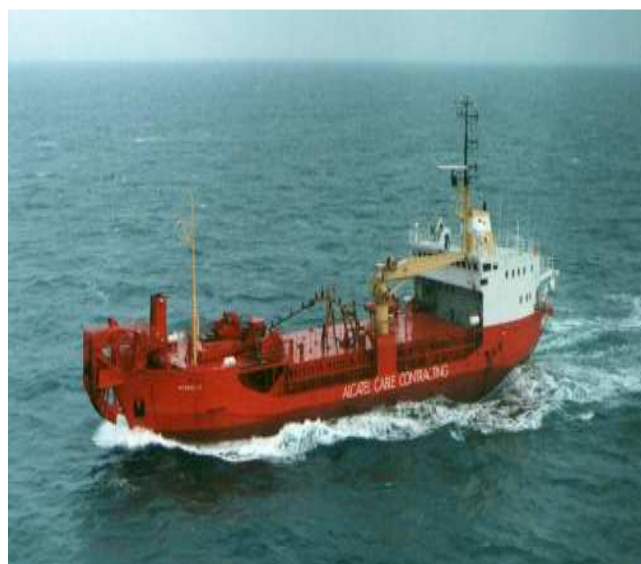
Εικόνα 4.23: Διάφορες λήψεις του CLV «STANELCO» Διακρίνεται ο εξοπλισμός ποντίσεως καθώς και του συστήμα διατήρησης θέσης κατά την πόντιση του καλωδίου
