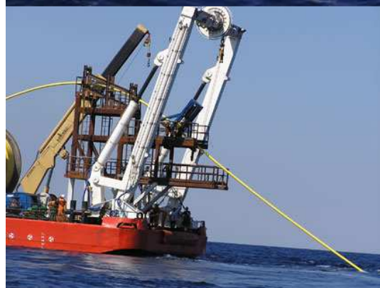
Εικόνα 4.25: Διάφορες λήψεις του CLV «ARGO II». Διακρίνεται ο εξοπλισμός ποντίσεως καθώς και το τύμπανο αποθήκευσης καλωδίου.
