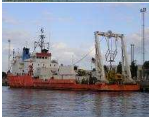
Εικόνα 4.25: Διάφορες λήψεις του CLV «ARGO II». Διακρίνεται ο εξοπλισμός ποντίσεως καθώς και το τύμπανο αποθήκευσης καλωδίου.
