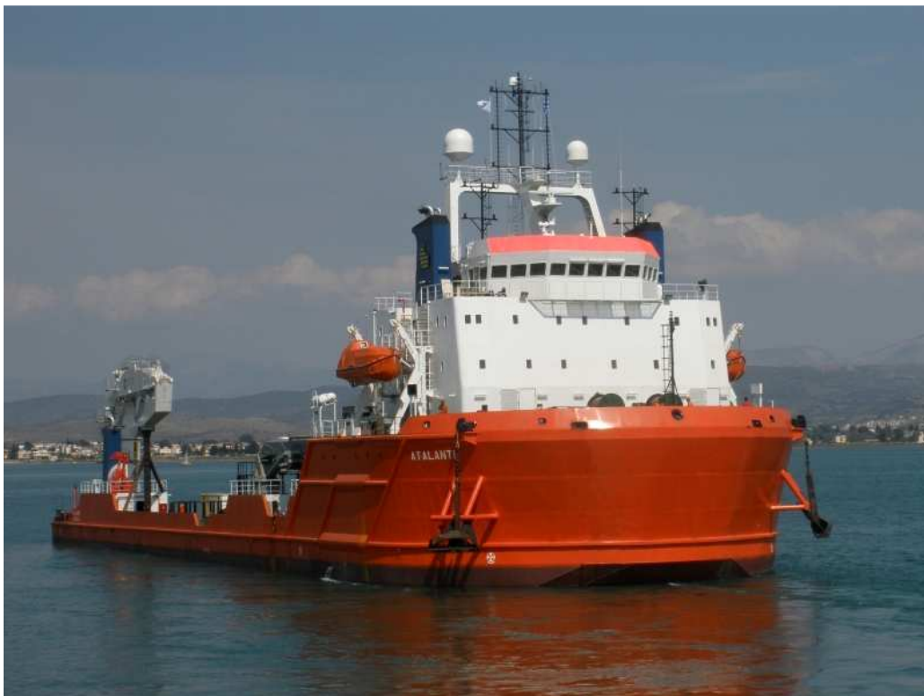
Εικόνα 4.20: CLV «ATALANTI». Διακρίνονται δύο άγκυρες στην πλώρη του πλοίου για υποβοήθηση στην διατήρηση θέσης κατά την πόντιση του καλωδίου
