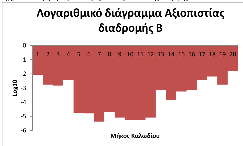
Σχήμα 6.20: Λογαριθμική ανάλυση αξιοπιστίας διασύνδεσης διαδρομής B
