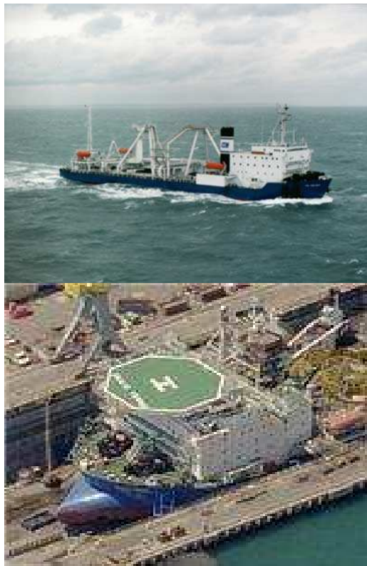
Εικόνα 4.17:Διάφορες λήψεις του CLV «GIULIO VERNE».Διακρίνονται τα μέσα φορτοεκφόρτωσης των καλωδίων ,η περιστρεφόμενη τράπεζα αποθήκευσης καθώς και ο εξοπλισμός ποντίσεως
