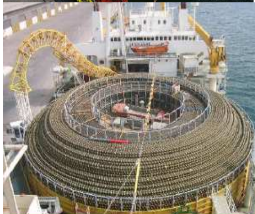
Εικόνα 4.15:Διάφορες λήψεις του CLV «SKAGERRAK».Διακρίνονται τα μέσα φορτοεκφόρτωσης των καλωδίων ,η περιστρεφόμενη τράπεζα αποθήκευσης καθώς και ο εξοπλισμός ποντίσεως.
