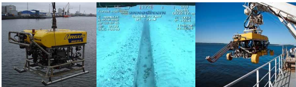
Εικόνα 4.11: Αριστερά, Δεξιά Υποβρύχιο όχημα ROV, Κέντρο απεικόνιση σε οθόνη εικόνας από ROV
