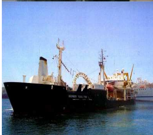
Εικόνα 4.15:Διάφορες λήψεις του CLV «SKAGERRAK».Διακρίνονται τα μέσα φορτοεκφόρτωσης των καλωδίων ,η περιστρεφόμενη τράπεζα αποθήκευσης καθώς και ο εξοπλισμός ποντίσεως.
