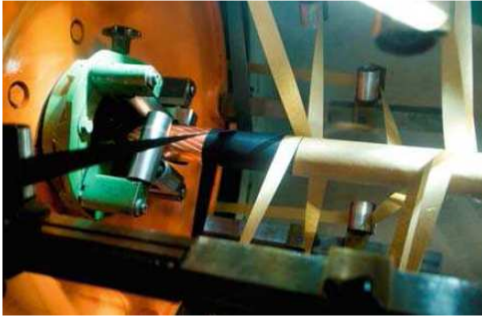
Εικόνα 2.11: Μηχανή απλώματος ταινιών στην επιφάνεια του αγωγού
