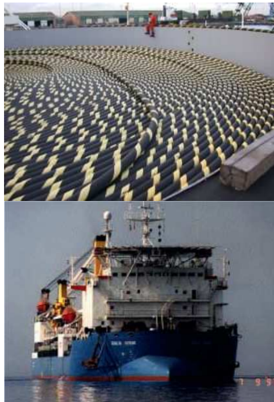
Εικόνα 4.17:Διάφορες λήψεις του CLV «GIULIO VERNE».Διακρίνονται τα μέσα φορτοεκφόρτωσης των καλωδίων ,η περιστρεφόμενη τράπεζα αποθήκευσης καθώς και ο εξοπλισμός ποντίσεως
