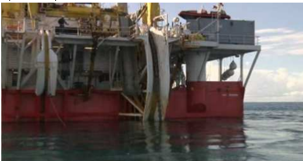
Εικόνα 3.8: Πόντιση καλωδίου από LCV
