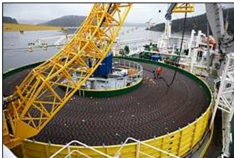
Εικόνα 4.2 : Φότρωση καλωδίου σε περιστρεφόμενη τράπεζα αποθήκευσης
