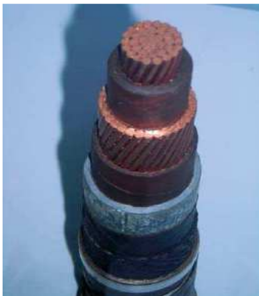
Εικόνα 2.8 : Ομοαξονικό καλώδιο διπλού αγωγού
