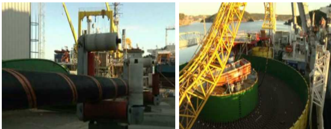
Εικόνα 3.5: Αριστερά Ράουλο επί της διαδρομής μεταφοράς καλωδίου Δεξιά Χώρος αποθήκευσης καλωδίου επί πλοίου
