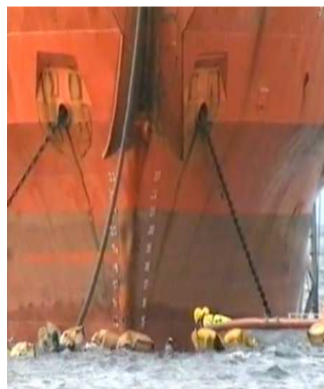
Εικόνα 4.23: Διάφορες λήψεις του CLV «STANELCO» Διακρίνεται ο εξοπλισμός ποντίσεως καθώς και του συστήμα διατήρησης θέσης κατά την πόντιση του καλωδίου
