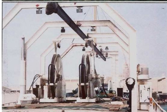
Εικόνα 4.28: Διάφορες λήψεις του CLV «ΙΚΑΡΟΣ» Διακρίνεται ο εξοπλισμός ποντίσεως καθώς και δύο τύμπανα αποθήκευσης καλωδίου
