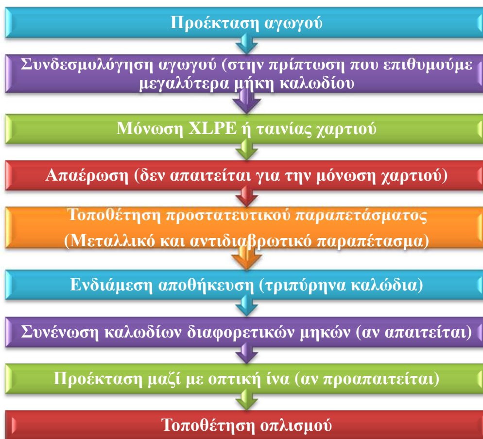
Σχήμα 2.5: Διάγραμμα σταδίων κατασκευή τριπολικού καλωδίου εναλλασσόμενου ρεύματος
