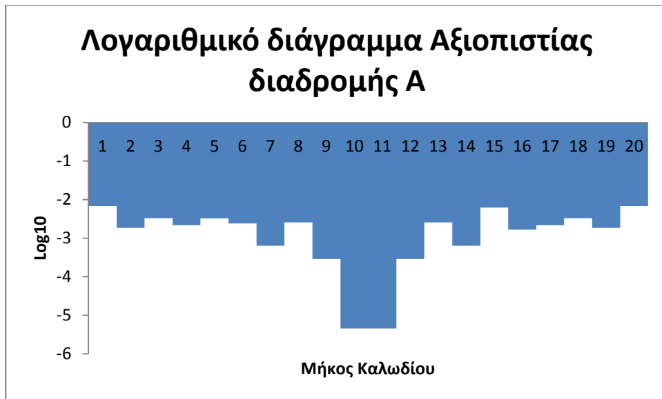
Σχήμα 6.19: Λογαριθμική ανάλυση αξιοπιστίας διασύνδεσης διαδρομής A
