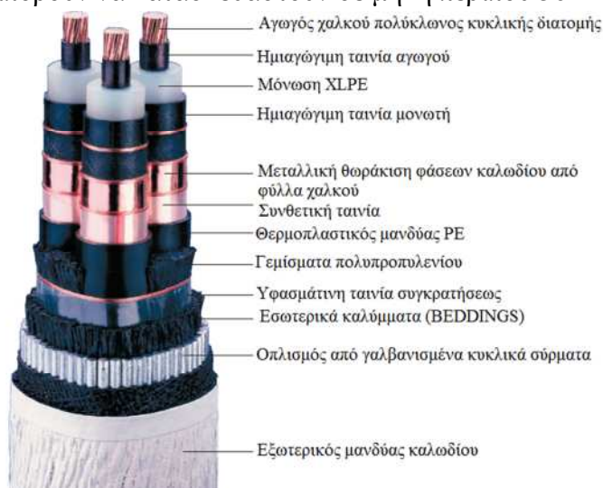
Εικόνα 2.5 :Υποβρύχιο καλώδιο MT από μόνωση XLPE
