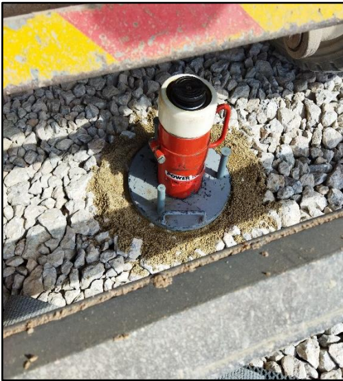
Εικόνες 2.25, 2.26 : Διάταξη δοκιμής φόρισης πλάκας και καταγραφή μετρήσεων
