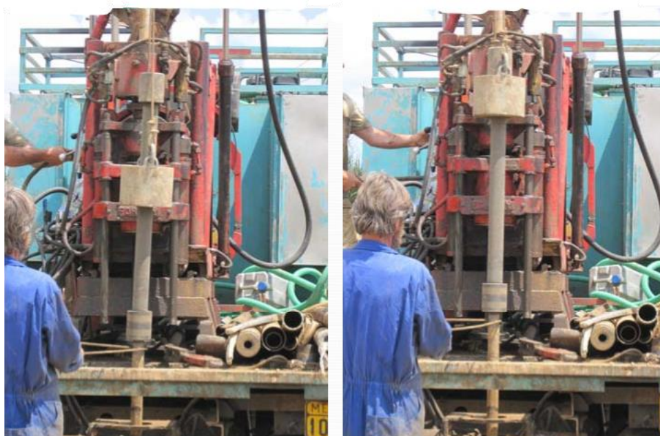
Εικόνα 2.22 : Διεξαγωγή δοκιμής SPT ( Λουπασάκης, 2013 )
