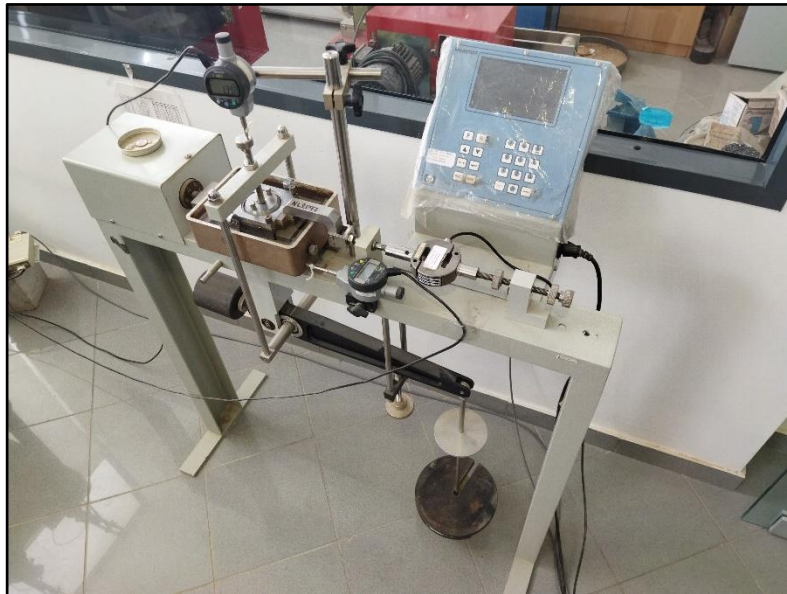
Εικόνα 2.16 – Διάταξη συσκευής δοκιμής άμεσης διάτμησης
