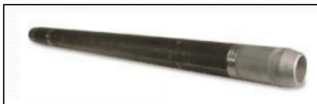
Εικόνα 2.21 : Διαιρετός δειγματολήπτης δοκιμής SPT (Λουπασάκης, 2013)
