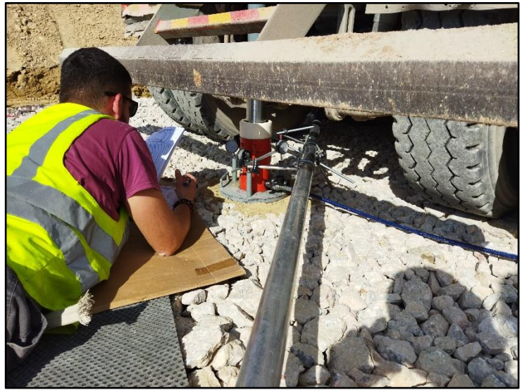
Εικόνες 2.25, 2.26 : Διάταξη δοκιμής φόρισης πλάκας και καταγραφή μετρήσεων
