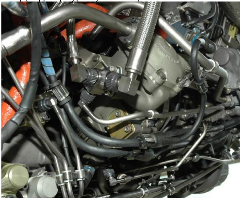
Εικόνα 2-38: Μεταλλάκτης καυσίμου λαδιού (Module20)
