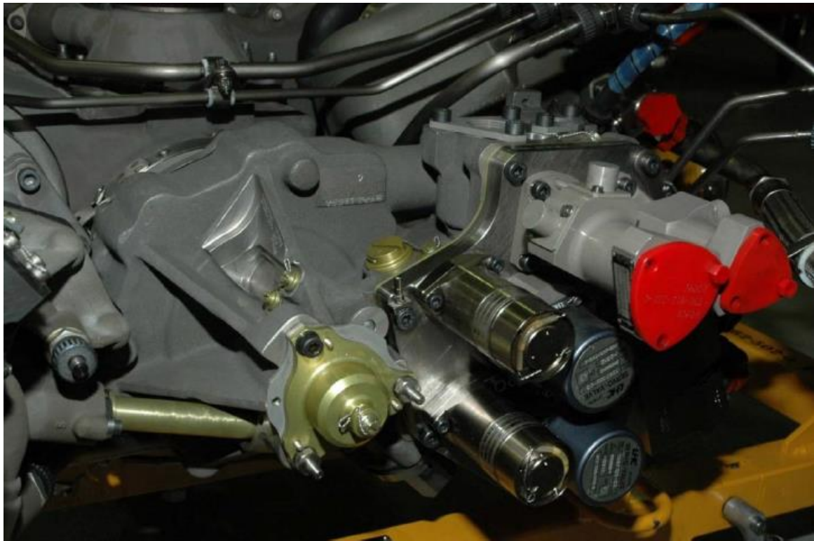
Εικόνα 2-36: Υδρομηχανικό σύστημα μετακαυστήρα ( Module 18)
