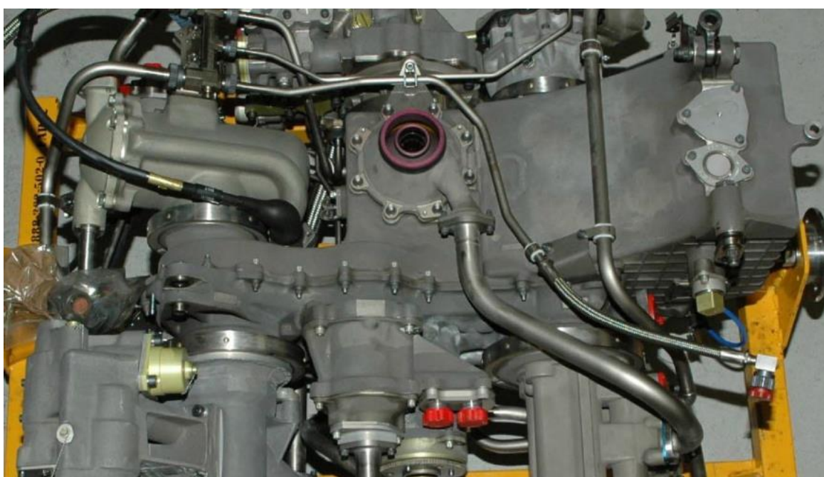
Εικόνα 2-29: Κιβώτιο ταχυτήτων ( Module 15)
