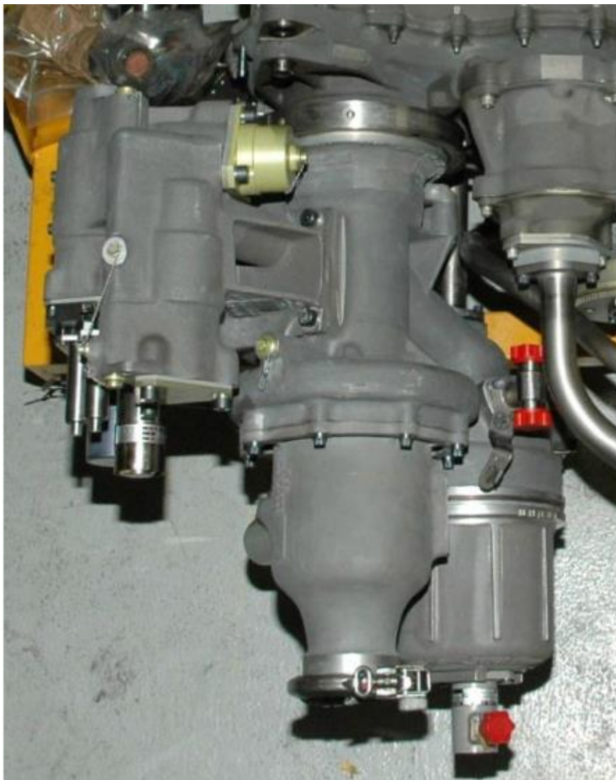
Εικόνα 2-35: Main hydromechanical unit
