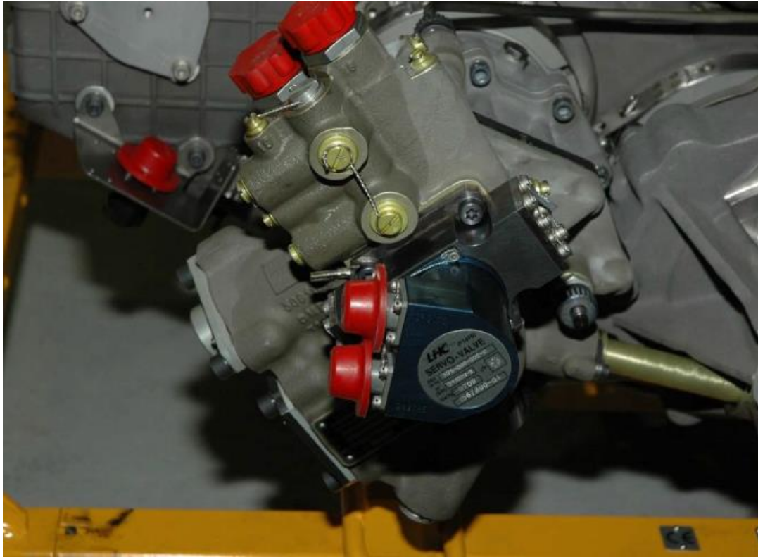
Εικόνα 2-37: Υδρομηχανική μονάδα ακροφυσίου ( Module 19)
