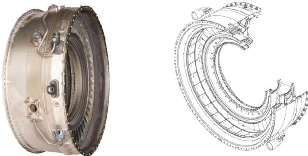
Εικόνα 2-18: Σταθερά πτερύγια στροβίλου χαμηλής πίεσης ( Module 9)
