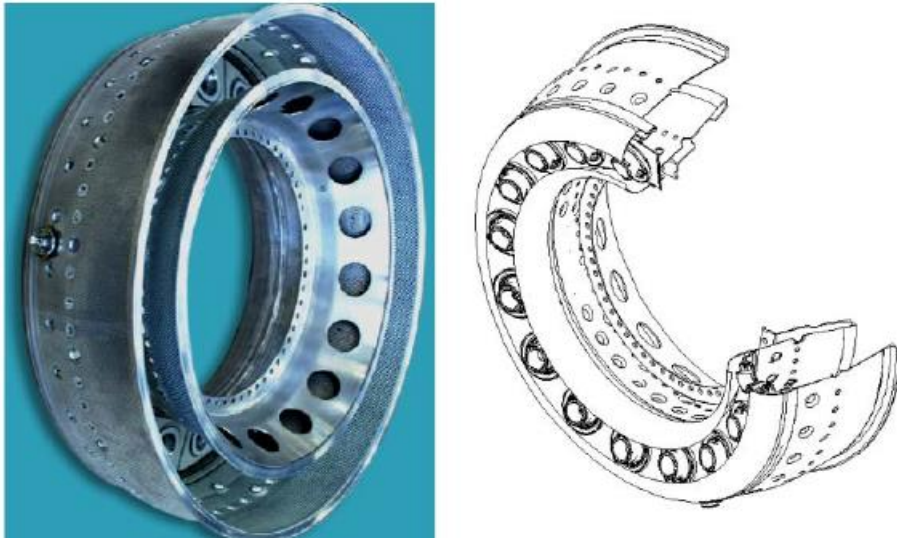
Εικόνα 2-12: Θάλαμος καύσης (Module 6- Combustion chamber)
