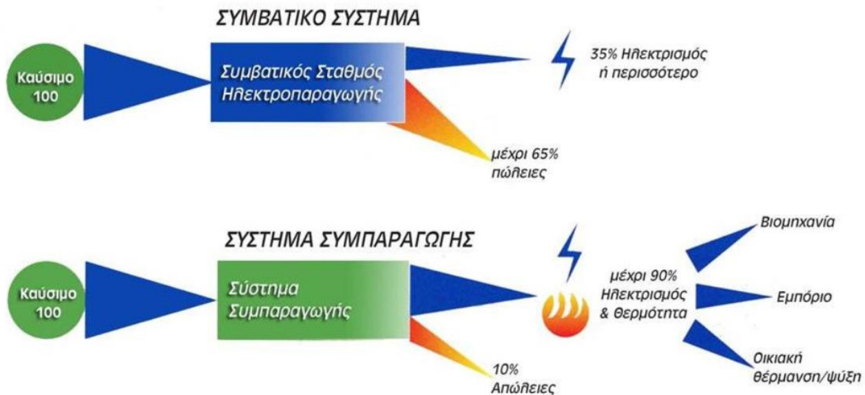
Εικόνα 1.6 Τυπική σύγκριση ως προς τον βαθμό απόδοσης συμβατικού συστήματος με σύστημα συμπαραγωγής
