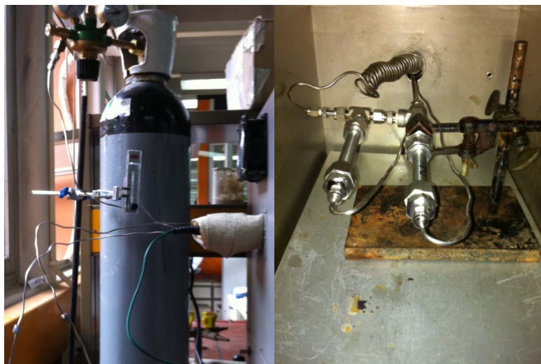
Εικόνα 6.1: Ροόμετρο μπίλιας συνδεδεμένο στη φιάλη φέροντος αερίου αζώτου (αριστερά). Σύστημα αντιδραστήρων τοποθετημένων μέσα στον φούρνο(δεξιά).
