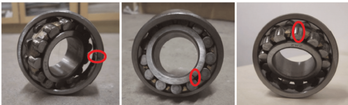
Σχήμα 2: Οι τρεις κύριες βλάβες των εδράνων κύλισης. Βλάβη στον εξωτερικό δακτύλιο, βλάβη στον εσωτερικό δακτύλιο και βλάβη στα έδρανα κύλισης αντίστοιχα. Πηγή: An, 2014 [3].
