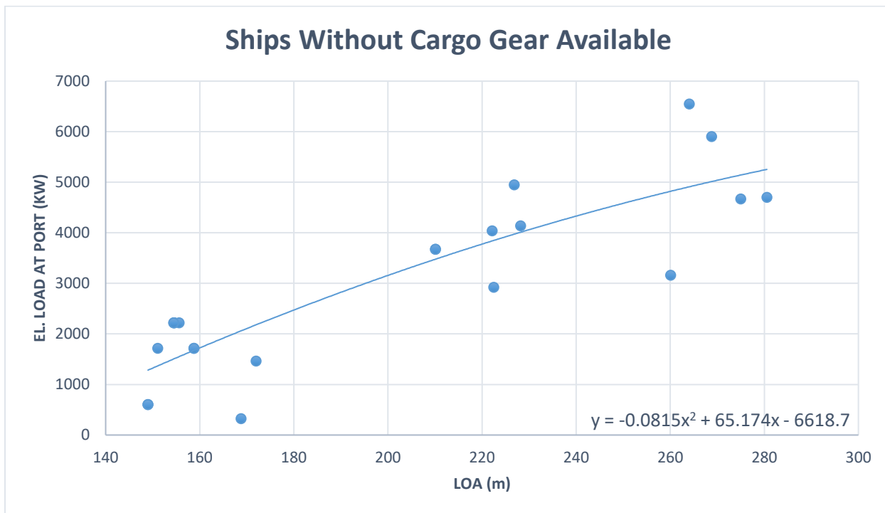
Εικόνα 19: Διάγραμμα ενεργειακών απαιτήσεων συναρτήσει του Ολικού Μήκους για πλοία χωρίς φορτοεκφορτωτικά μέσα
