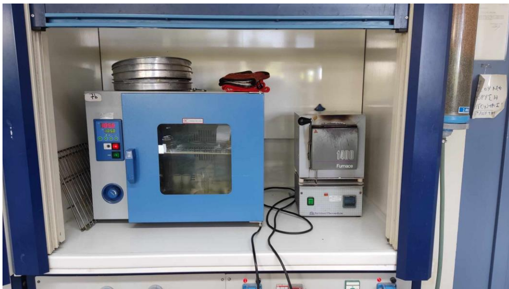
Εικόνα 31: Φούρνος μέτρησης TS, TSS (αριστερά). Φούρνος μέτρησης VS, VSS (δεξιά).
