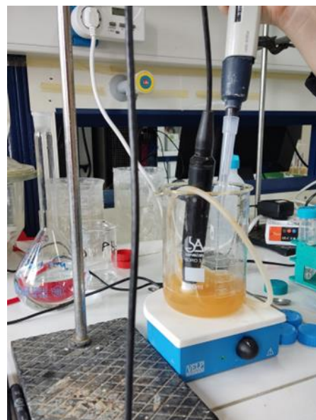
Εικόνα 27: Πειραματική διάταξη αντιδραστήρα συσσώρευσης PHA.
