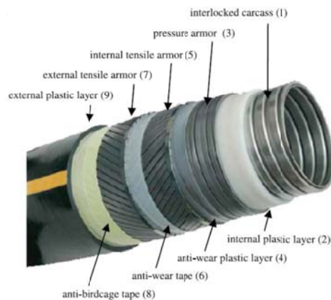
Σχήμα 1.2: Τυπική κατασκευή εύκαμπτου σωλήνα [Vaz & Rizzo 2011]
