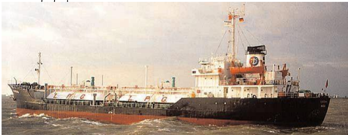
Εικόνα 16: Πλοίο μεταφοράς αερίων σε κατάσταση πλήρους πίεσης (fully pressurized gas carrier) (Bosneagu,Vasilache&Raiciu,2017)
