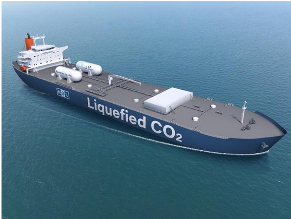
Εικόνα 33: LCO 2 64.000m 3 , που αναπτύχθηκε από την εταιρεία «Mitsui O.S.K. Lines» (Πηγή: https://www.marinelog.com/news/lco2-carrier-developments-set-to-pick-up-pace/ )
