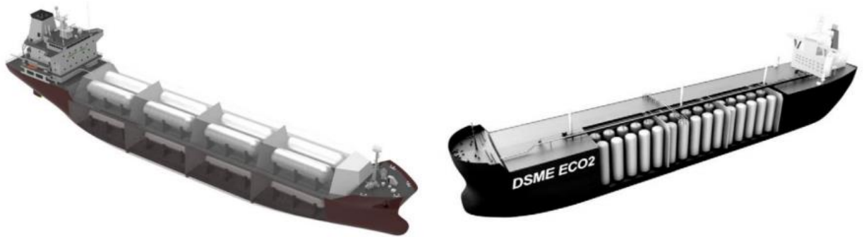
Εικόνα 42: Προτεινόμενοι σχεδιασμοί πλοίων για την μεταφορά υγροποιημένου CO 2 , μεταφορική ικανότητας 12310 tCO 2 (αριστερά) και 105.000 tCO 2 (δεξιά). Πηγή: (Element Energy, 2018)
