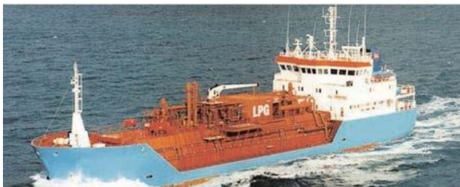
Εικόνα 17: Πλοίο μεταφοράς αερίων σε κατάσταση ημιπίεσης (semi-pressurized gas carrier) (Bosneagu, Vasilache & Raiciu, 2017)
