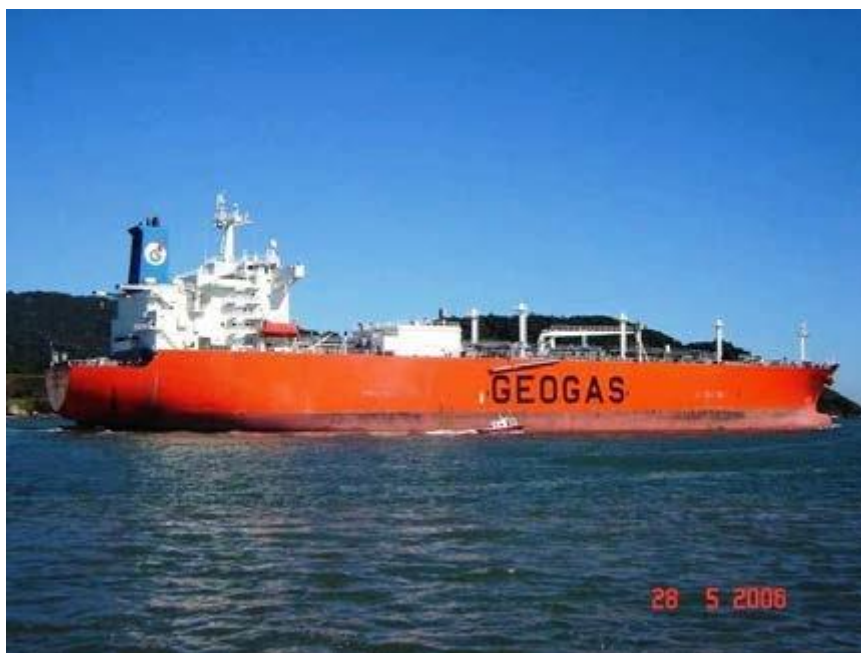
Εικόνα 18: Πλοίο μεταφοράς αερίων σε κατάσταση πλήρους ψήξης (fully refrigerated gas carrier) (Bosneagu, Vasilache & Raiciu, 2017)
